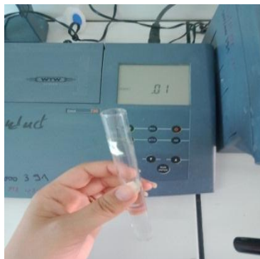
Figure 9. Mesure de la conductivité électrique avec le conductimètre (Originale, 2022).
