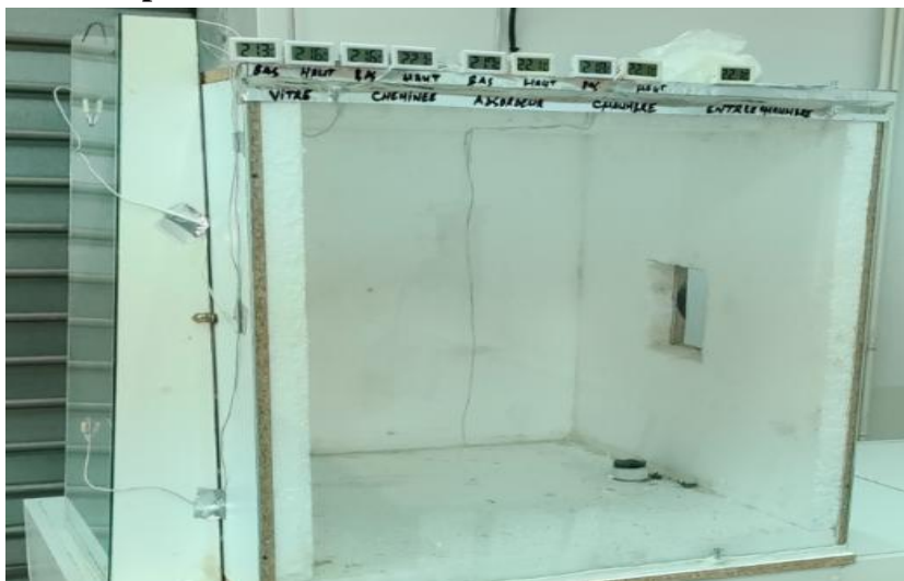
Figure 4.5 : Emplacement des sondes de Température.
