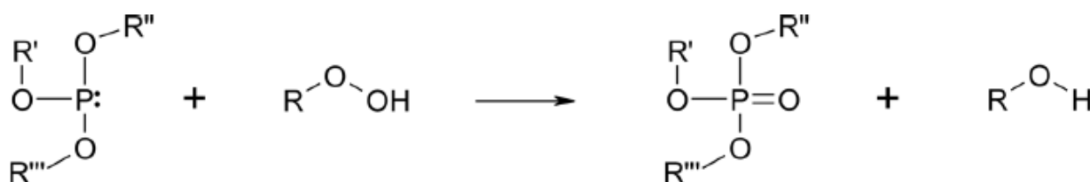
Schéma III.1 : Réaction des phosphites avec les hydroperoxydes
