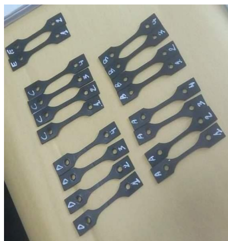
Figure II.5: Éprouvette du test de NCTL.
