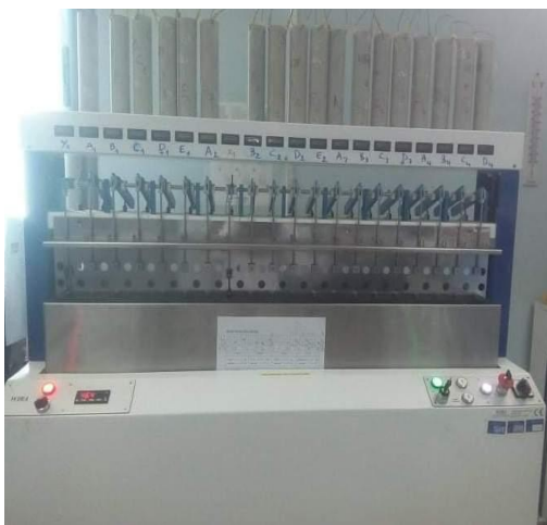
Figure II.4: Équipement du test NCTL.
