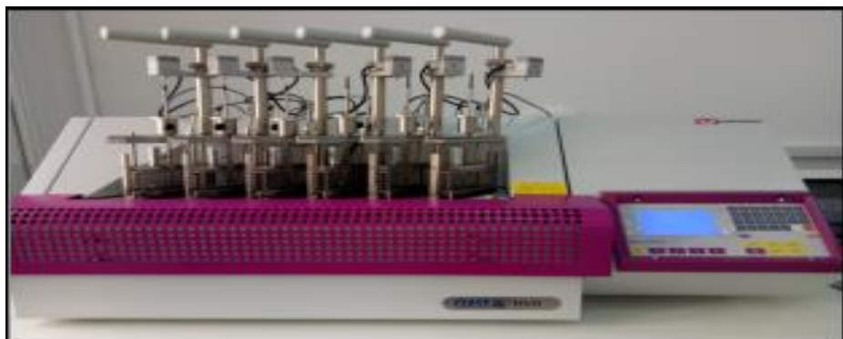
Figure II.1 : Vue d'ensemble de l'appareil de mesure HDT-VICAT.
