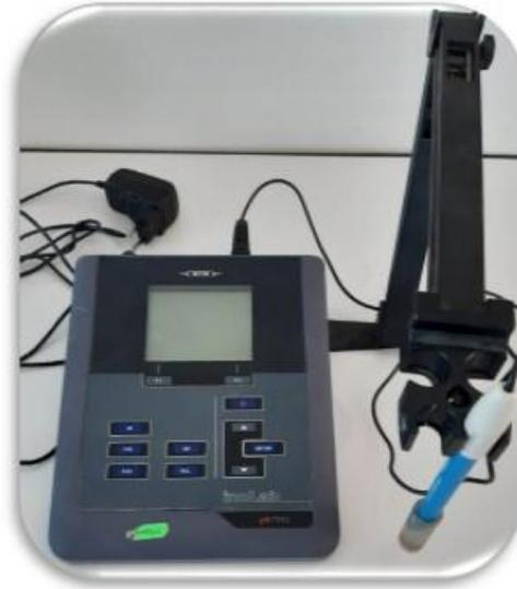
*Figure II.7:* pH-mètre de paillasse
