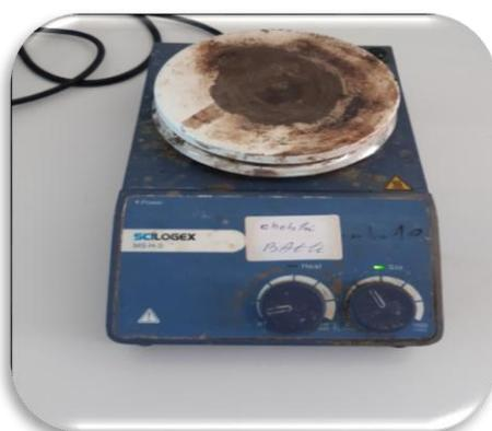
Figure II.5: Agitateur magnétique
