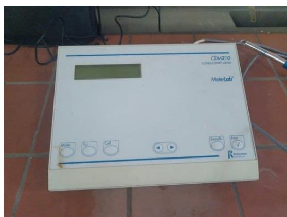
Figure II. 3. Appareil de mesure de la conductivité molaire des produits préparés.
