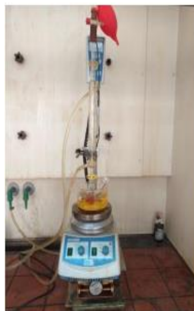
Figure II. 1. Montage à reflux utilisé pour la synthèse du ligand et du complexe de manganèse correspondant.
