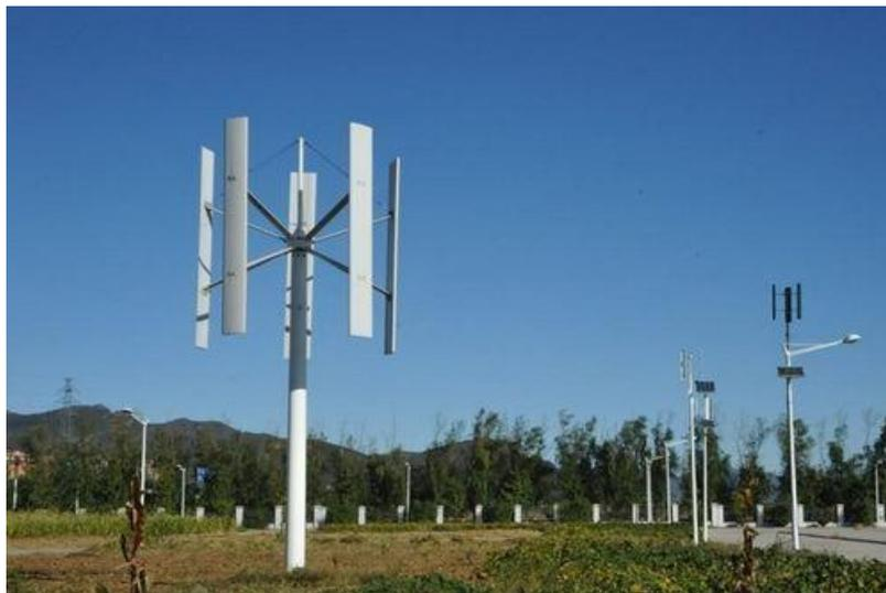
**Figure 1.5** : Éolienne à axe verticale [10]
