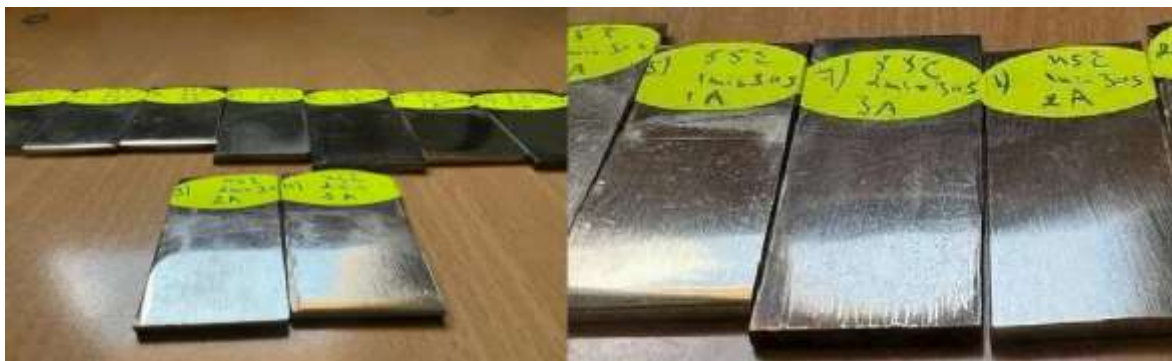
Figure II.2 : Dépôt de nickel brillant (sds ;glycérol ;formaldéhyde)
