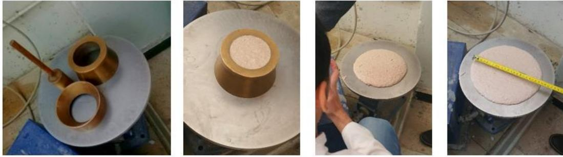
Figure III- 8: Table à choc pour l'essai d'étalement
