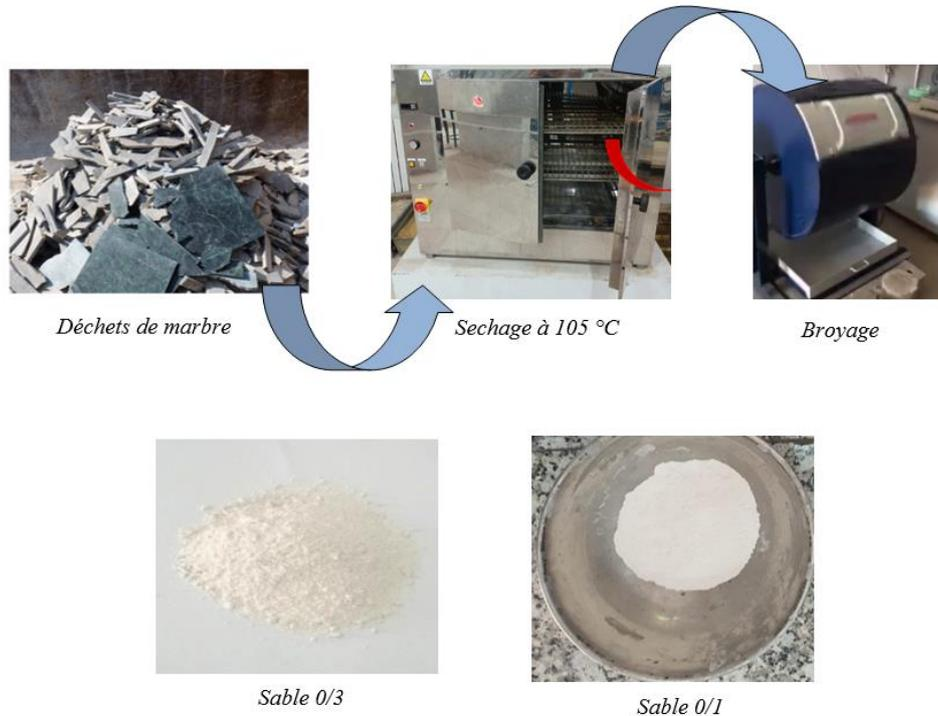
Figure III- 3: Méthode de broyage des déchets de marbre
