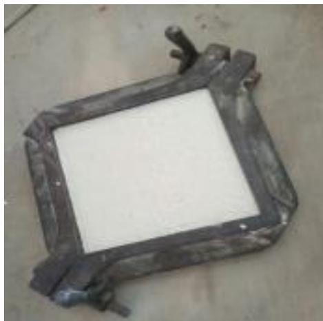
Figure III- 7: Mode de fabrication du carrelage à base de déchets de marbre
