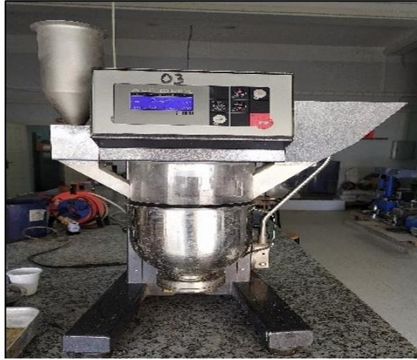
Figure III- 5: Malaxeur à mortier
