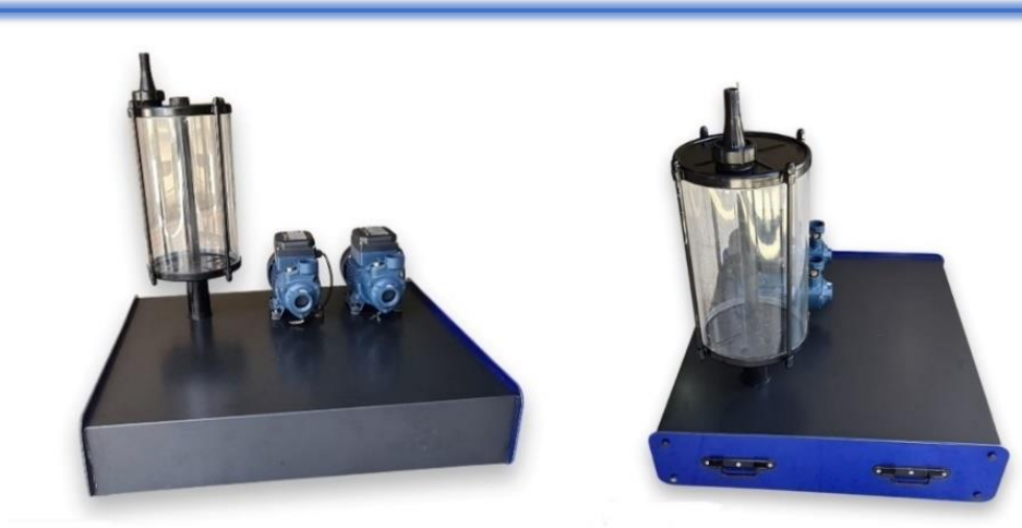
Figure. 3.4. Montage du réservoir sur le banc d'essai.
