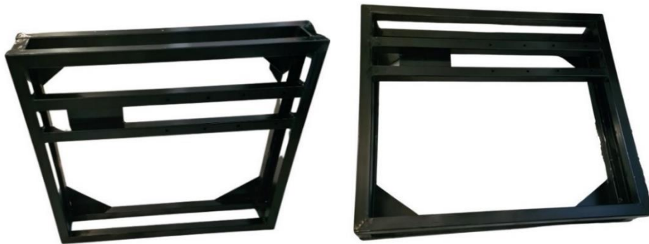
Figure. 3.1. Structure du châssis après soudure et revêtement.
