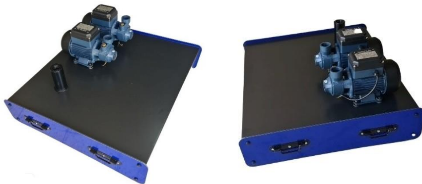
Figure. 3.3. Banc d'essai après l'installation des deux pompes.
