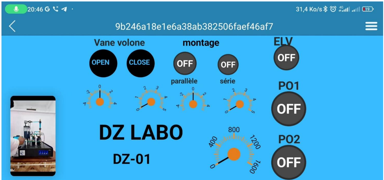
Figure. 3.7. Interface développée pour le contrôle du banc d'essai.
