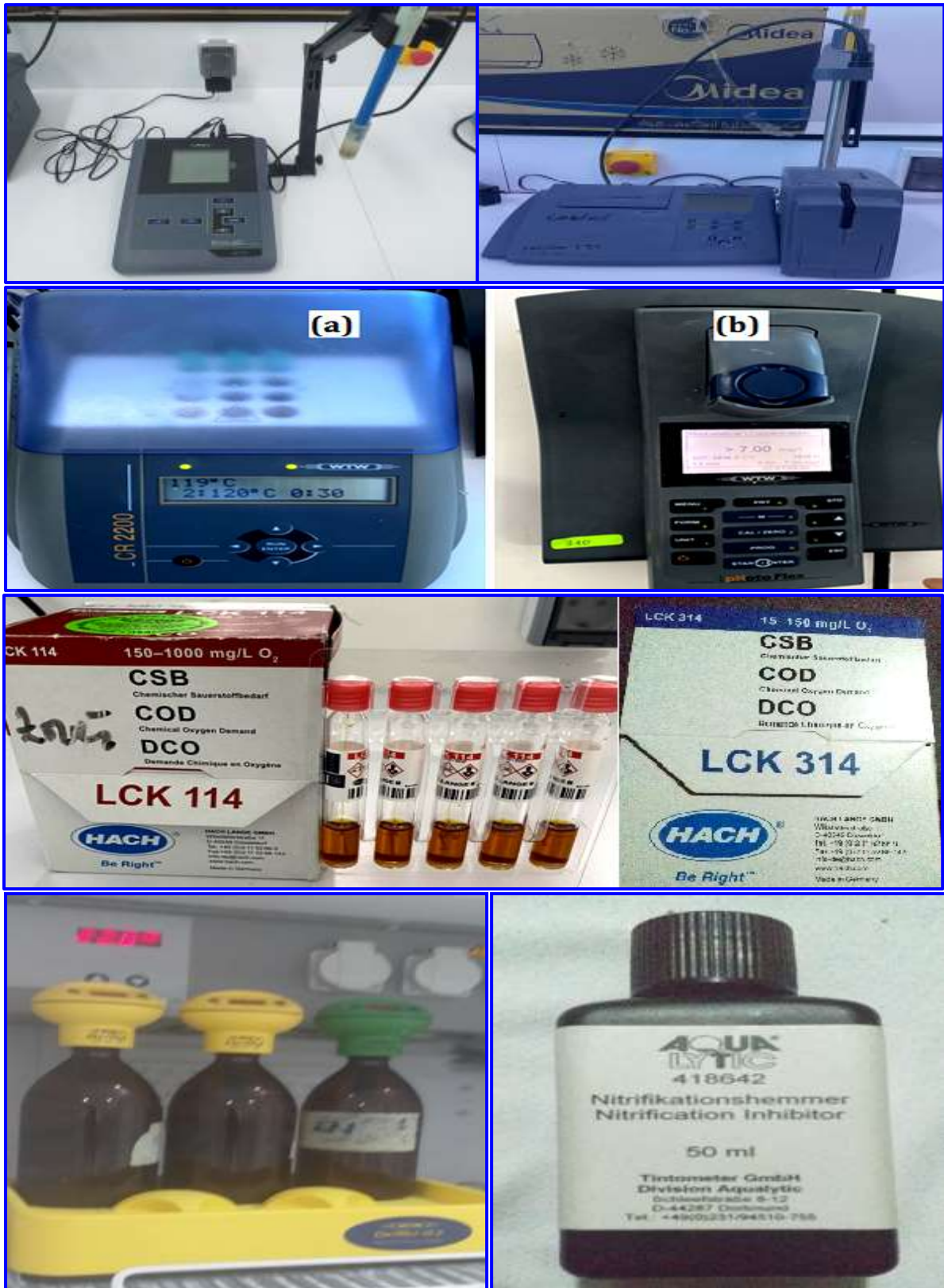
a Conductimètre WTW c Thermo réacteur CR 2200. e Réactifs g Nitrification inhibitor.
