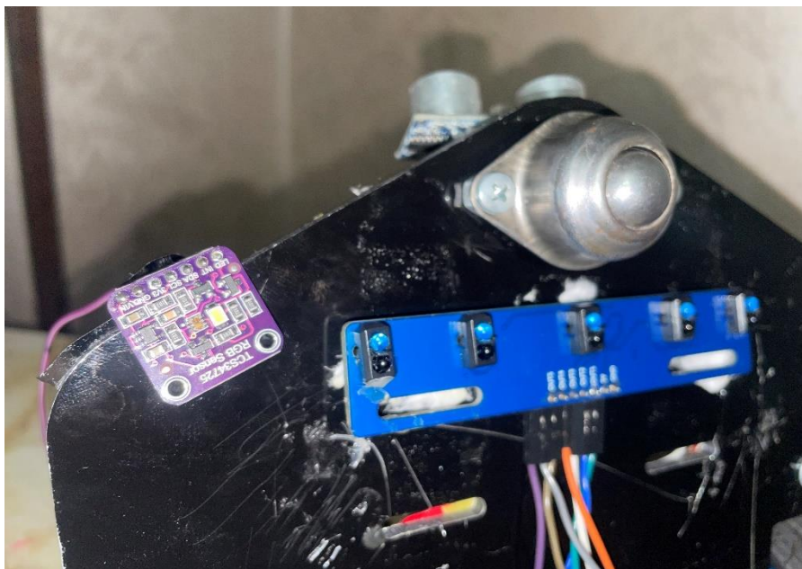
Figure 10: Installation du capteur couleur sur le robot
