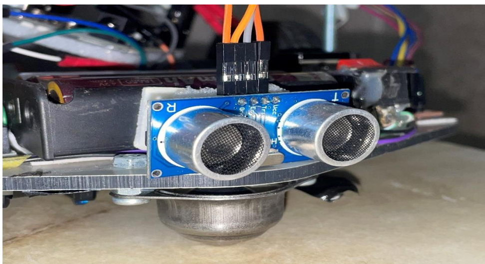
Figure 12: Installation du capteur Ultrason sur le robot
