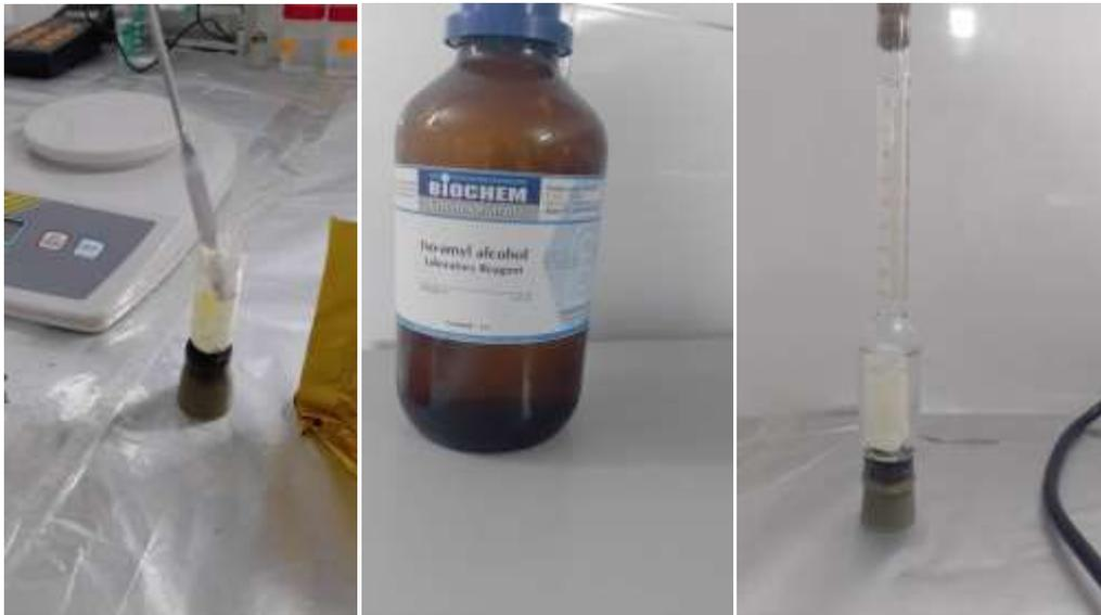
FIGURE N°24 : détermination de la matière grasse (photographie originale)
