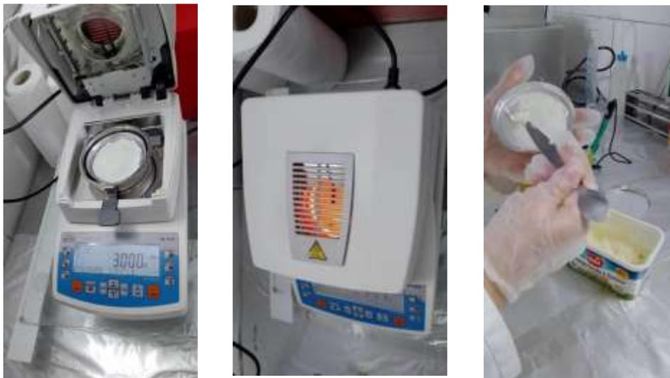
**FIGURE N°23 : determination de l'extrait sec total (photographie originale)**
