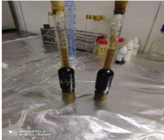
**Figure N°28** : résultat d'analyse de la matière grasse du fromage (**photographie originale**)
