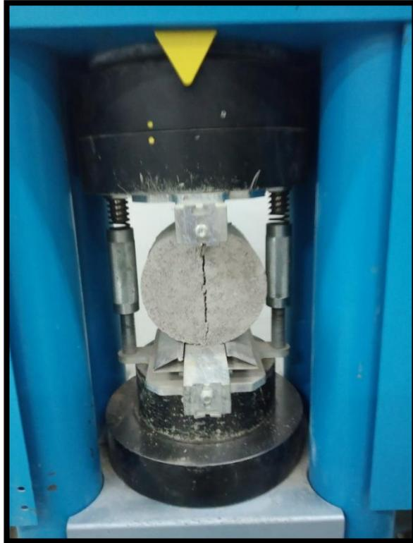
**Figure III.12 :** Ecrasement d'éprouvette.
