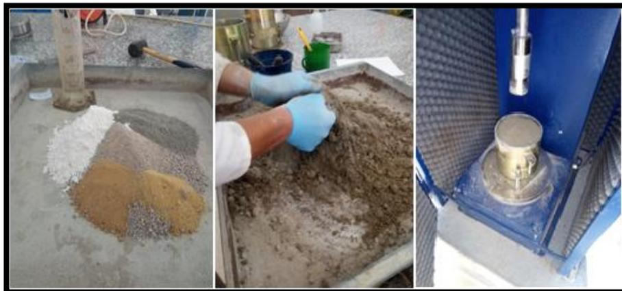
Figure III.6. Préparation et réalisation de l'essai Proctor modifier.
