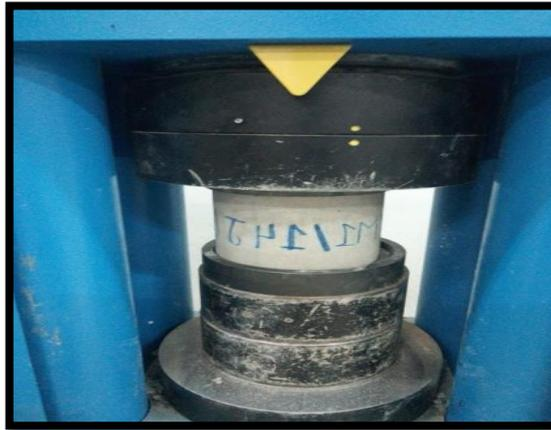
**Figure II.13.** Essai d'écrasement (Résistance à la compression).
