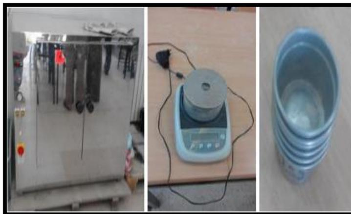
Figure II.9. Appareillage –Teneur en eau (NF P 94-050).
