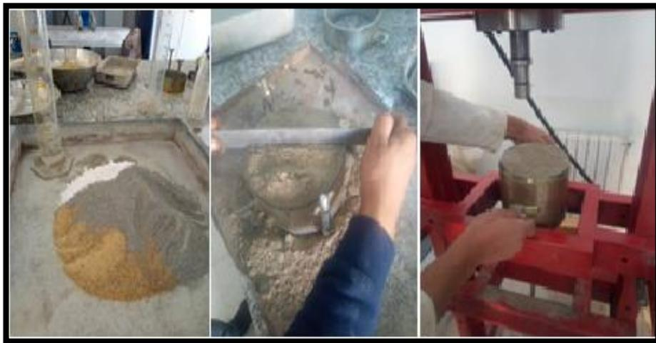
**Figure II.10.** Essai de compactage des éprouvettes.
