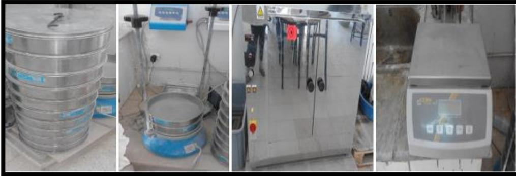
**Figure II.5.** Appareillage – essai granulométrique.
