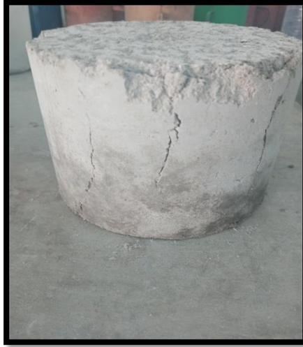
Figure III.10 : Epreuve après essai de compression.
