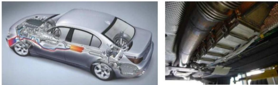
**Figure III.14** Conception d'un générateur thermoélectrique produisant de l'électricité de la chaleur perdue au niveau du pot d'échappement d'un véhicule (source BMW) [45].
