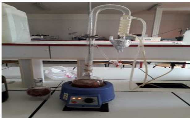
Photographie 03: Dispositif d'extraction des huiles essentielles de type Clevenger.
