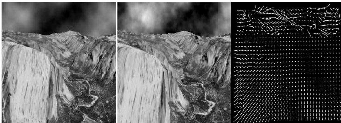
Figure 2.5 La séquence de test Yosemite À gauche et au milieu : une paire d'images extraites de la séquence. À droite : le flot optique estimé par la méthode de B.Horn and B.Schunck [26].
