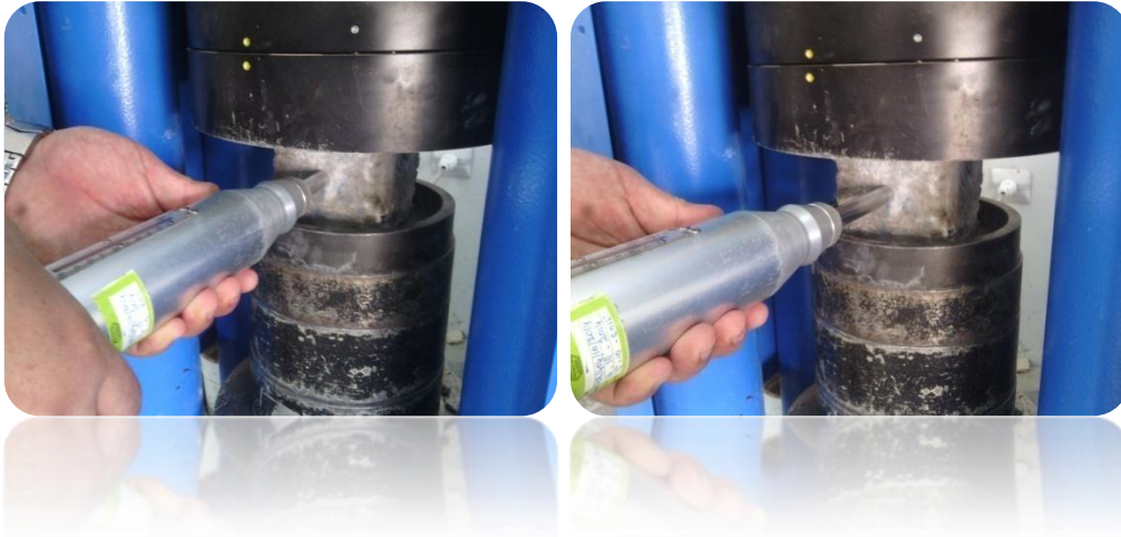
Photo II.10 : Mesurer la dureté superficielle du béton
