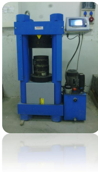
Photo II.11: Presse hydraulique capacité 3000 KN
