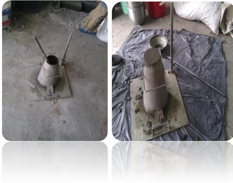
Photo II.7 : Affaissement au cône d'abrams
