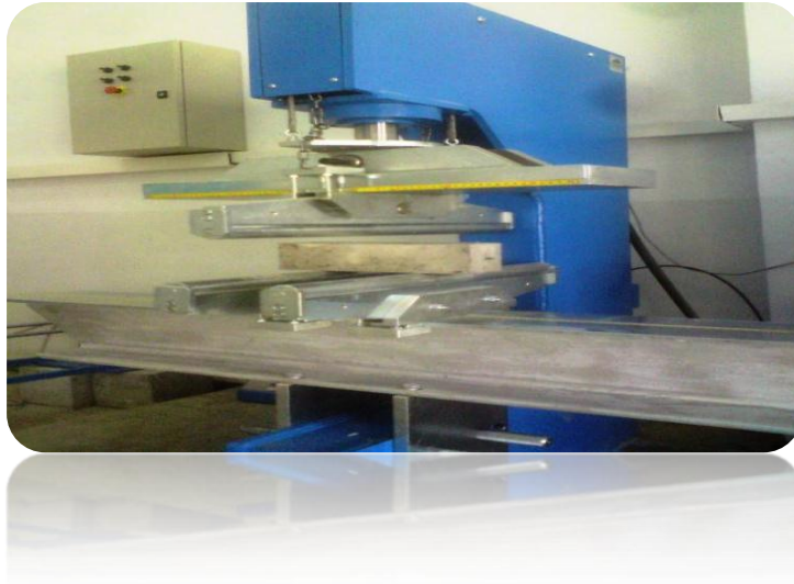
Photo II.12: Appareil de traction par flexion
