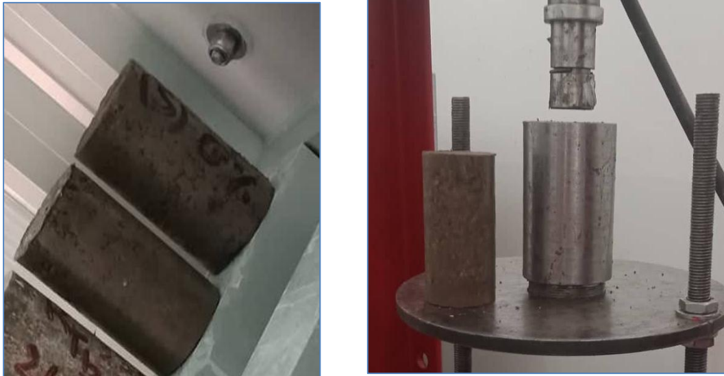
Figure 54 : Confection des éprouvettes à partir du sol non traité.
