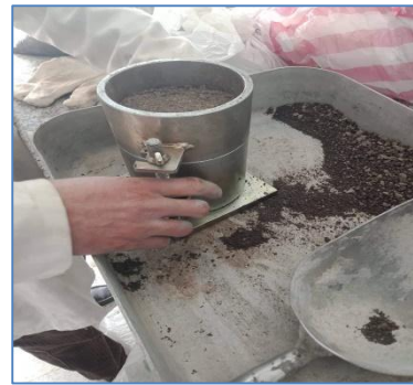
Figure 34 : Remplissage par 3 couches.
