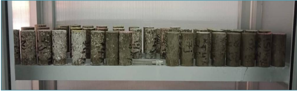
Figure 61 : Conservation des éprouvettes des différents pourcentages des 2 types d'chaux.
