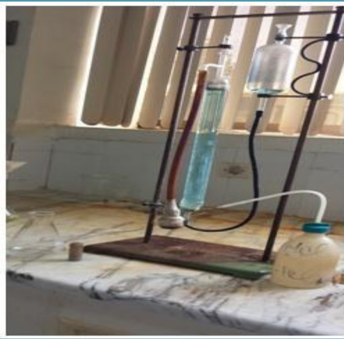
Figure 45 : Calcimètre Dietrich-Fruhling utilisé
