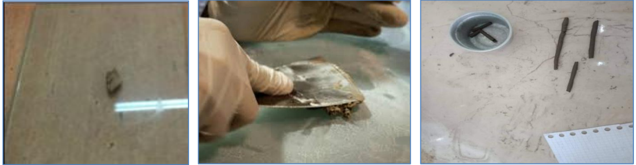
Figure 32 : Préparation du rouleau pour la détermination de WP.
