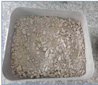
Figure 33 : sol sec concassé.
