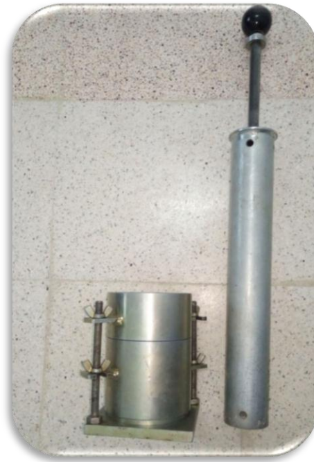
Figure III.9 : Moule et dame de compactage de l'essai Proctor normal.
