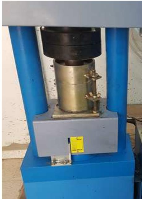
**Figure 2.9:** Compactage de l'éprouvette
