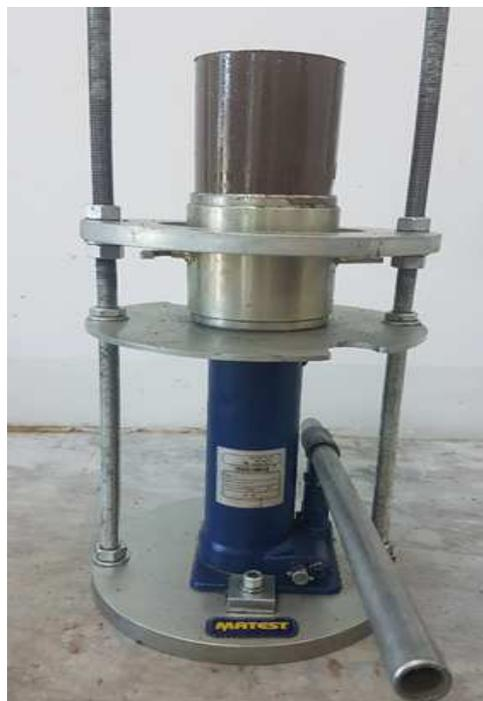
**Figure 2.10:** Démoulage de l'éprouvette
