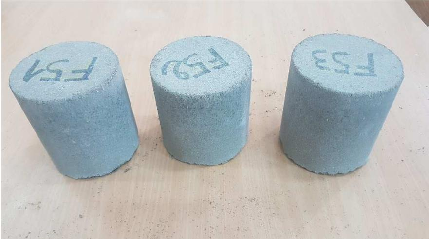
Figure 3.28. Éprouvettes F5 après 12 cycles de séchage/mouillage
