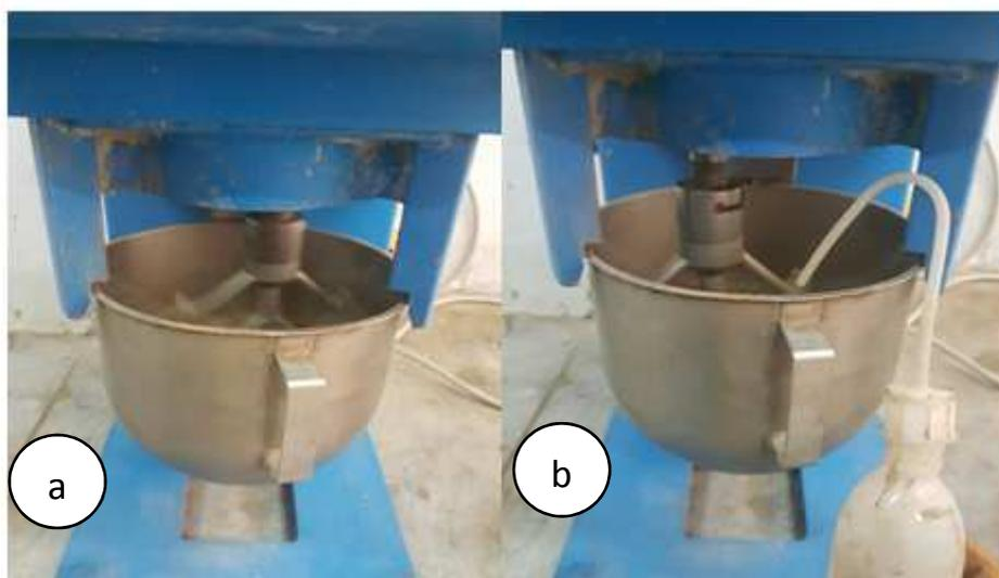
**Figure 2.6:** Malaxage à sec (a), avec l'eau (b).
