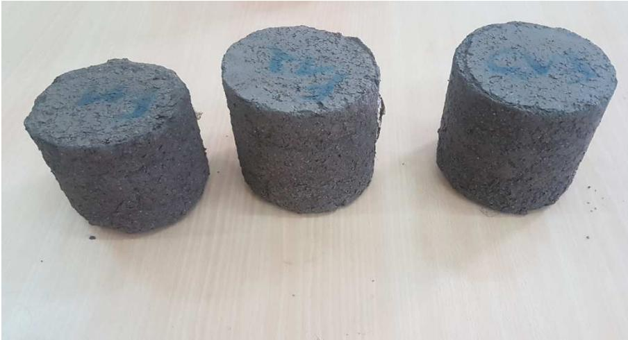
Figure 3.20. Éprouvettes F1 après 12 cycles de séchage/mouillage
