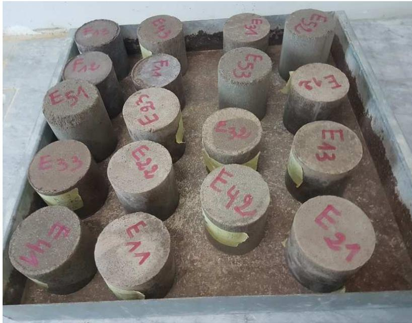
Figure 2.12: Conservation des éprouvettes au laboratoire.
