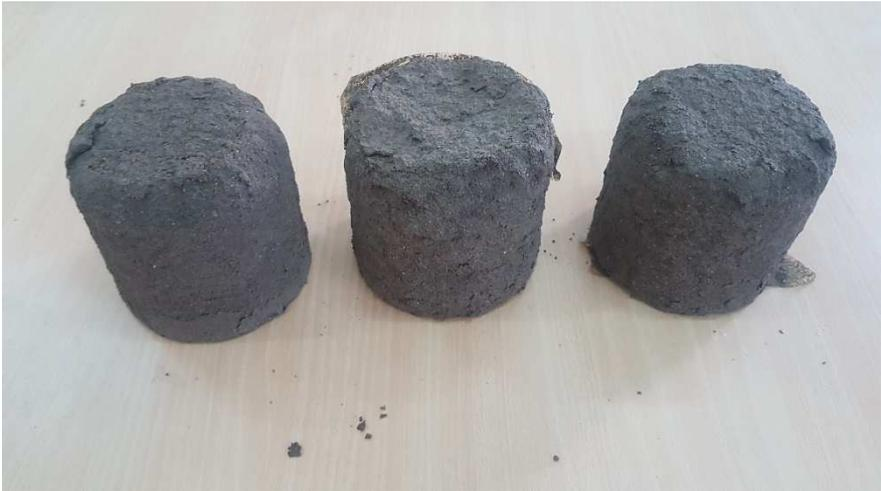
Figure 3.12. Éprouvettes E2 après 12 cycles de séchage/mouillage
