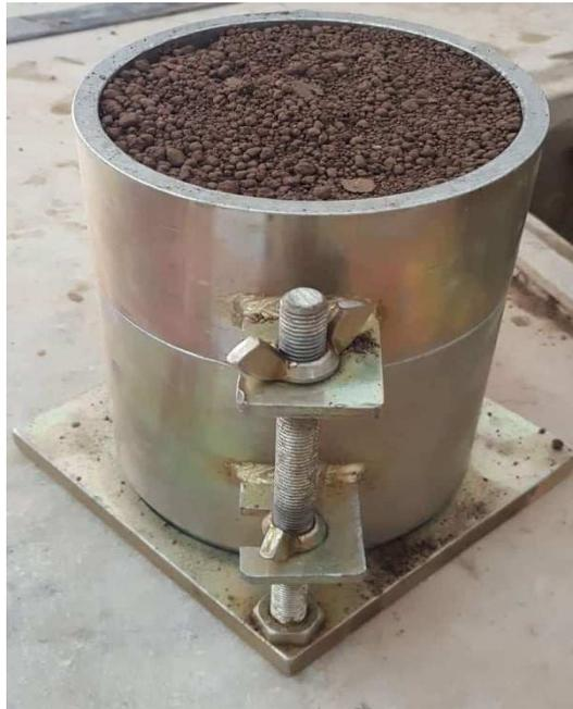
**Figure 2.7:** Mise en place du matériau dans le moule.
