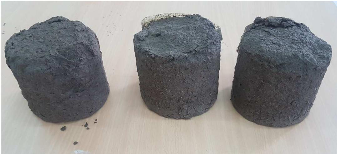
**Figure 3.10.** Éprouvettes E1 après 12 cycles de séchage/mouillage
