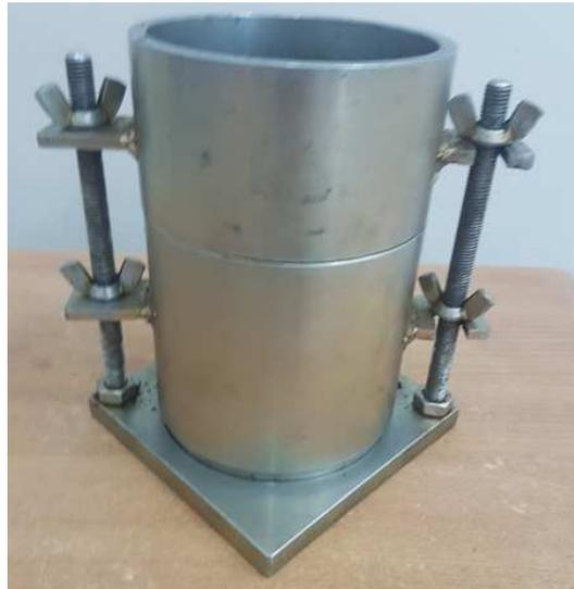
**Figure 2.4:** moule cylindrique utiliser pour la fabrication des BTC.
