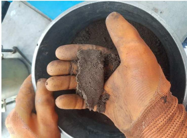
**Figure 2.8:** Mélange homogène visuellement
