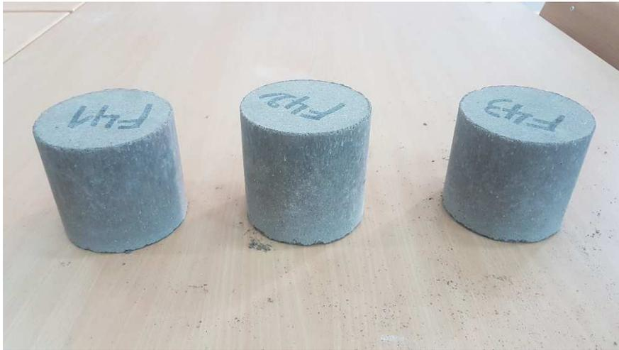
**Figure 3.26.** Éprouvettes F4 après 12 cycles de séchage/mouillage
