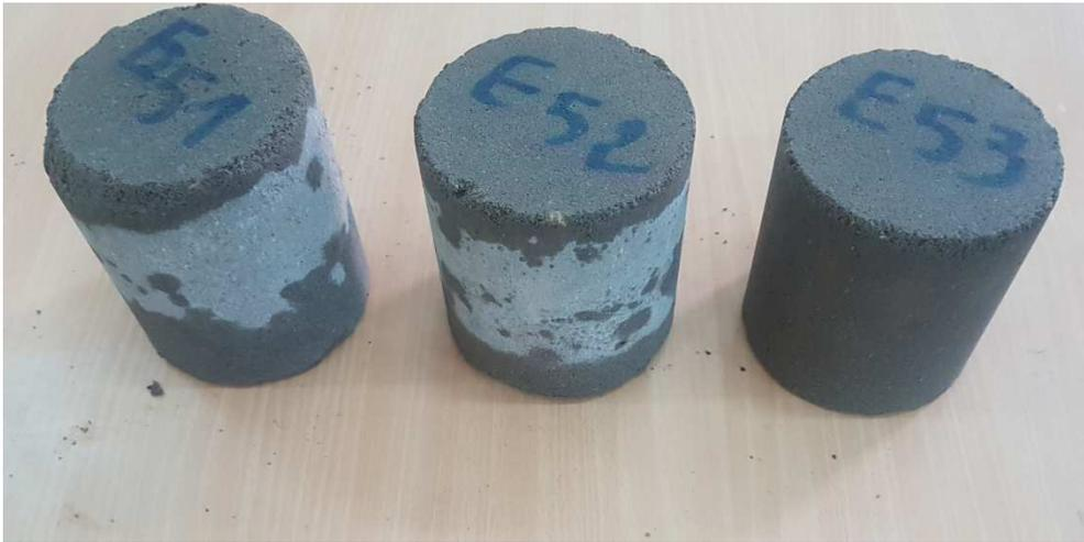
**Figure 3.18.** Éprouvettes E5 après 12 cycles de séchage/mouillage
