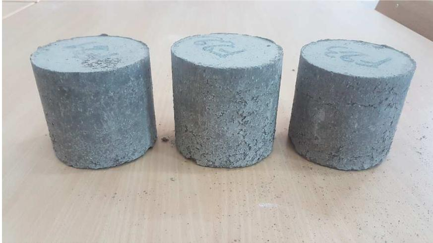
**Figure 3.22.** Éprouvettes F2 après 12 cycles de séchage/mouillage
