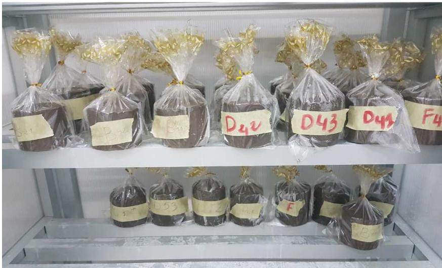
**Figure 2.11:** Conservation des éprouvettes.
