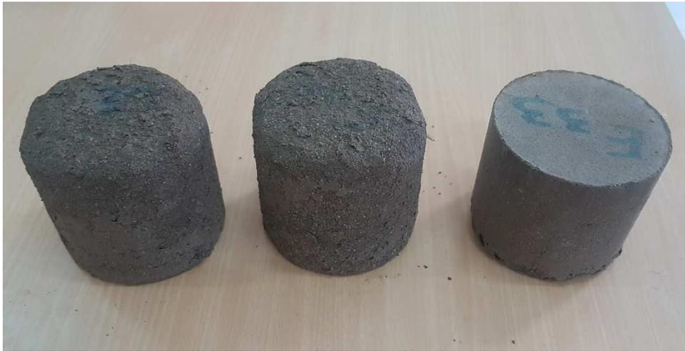
**Figure 3.14.** Éprouvettes E3 après 12 cycles de séchage/mouillage.
