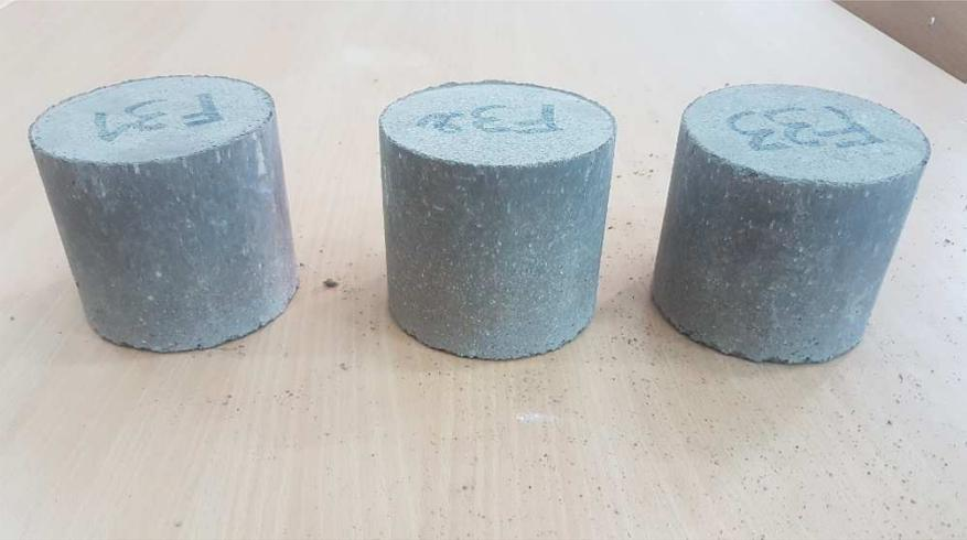
Figure 3.24. Éprouvettes F3 après 12 cycles de séchage/mouillage
