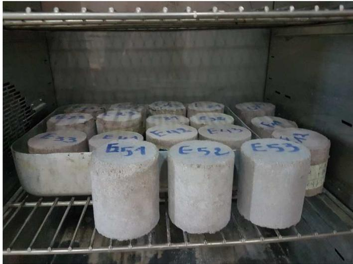
**Figure 2.15:** Éprouvettes séchées dans l'étuve.
