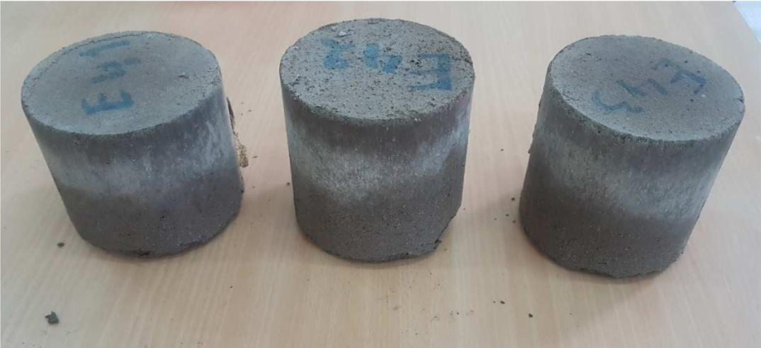
Figure 3.16. Éprouvettes E4 après 12 cycles de séchage/mouillage
