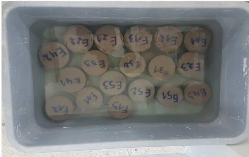
Figure 2.14: Eprouvette émergée dans l'eau.
