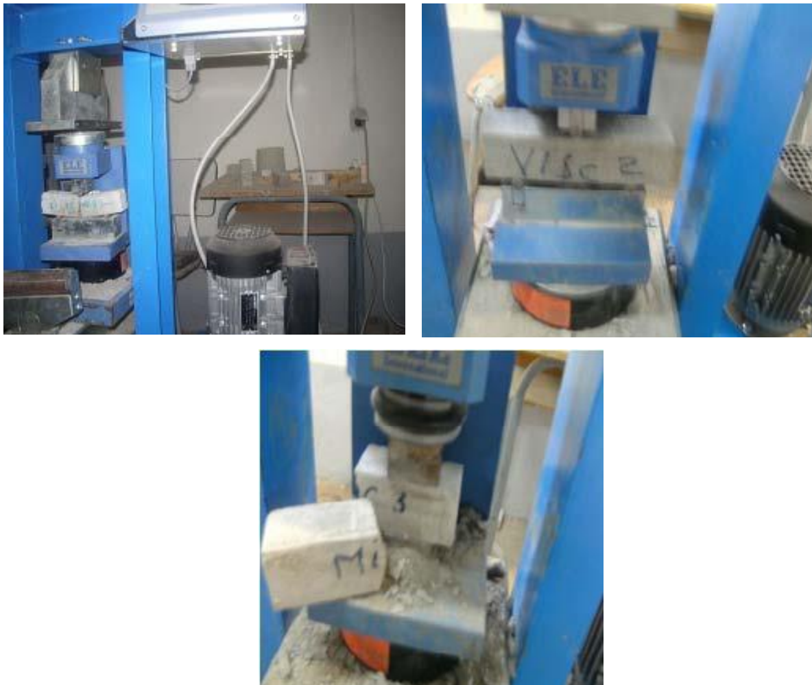
Figure 18 : Presse pour les essais de flexion et de compression sur éprouvettes 4 \times 4 \times 16 \text{ cm}^3 .
