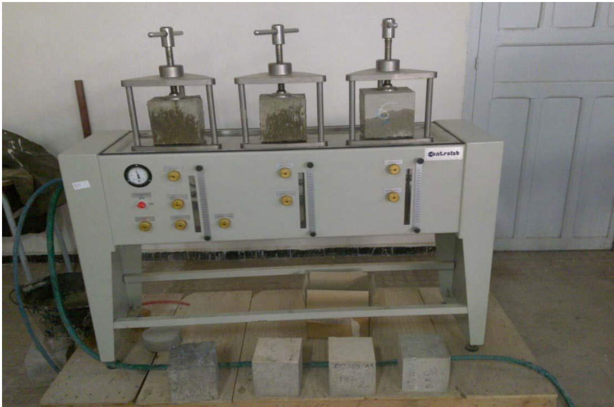
Figure 23 : Essais de perméabilité à l'eau.
