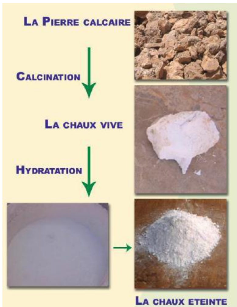
Figure 2.13: fabrication de la chaux éteinte
