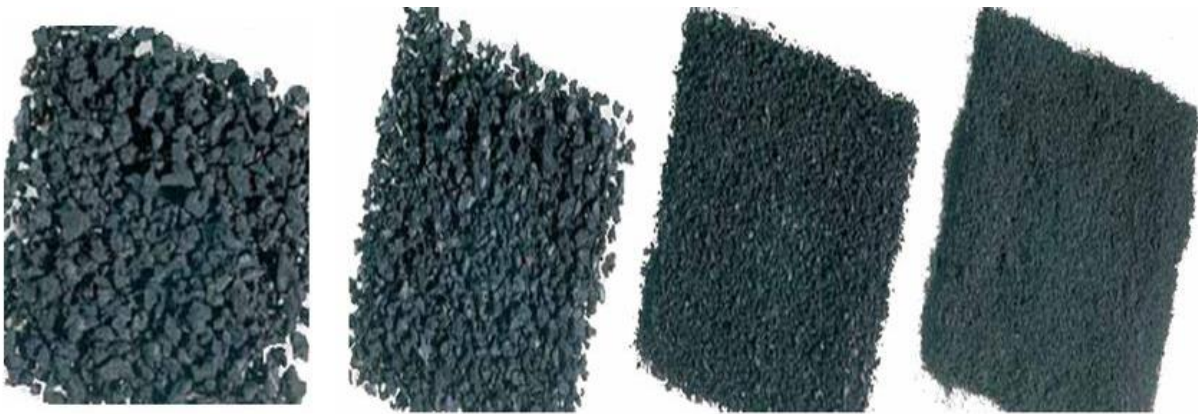
Granulés de 4 à 5mm Granulés de 2 à 4mm Granulés de 0.5 à 2mm Granulés inférieur à 0.5mm
