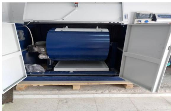
Figure III.7: Appareil de l'essai Los Angeles
