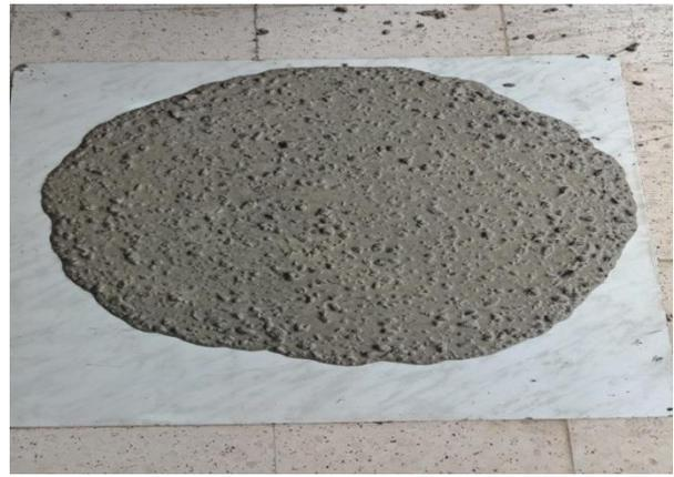
**Figure III.11 : Essai au cône d'Abrams**
