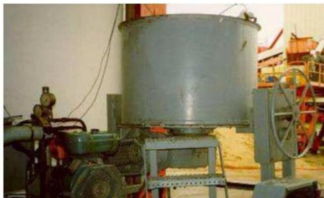
*Figure II.1.4 : Rhéomètre à béton du Cemagref [49]*
