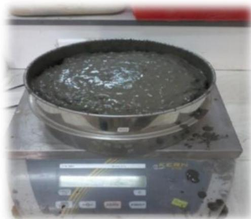
**Figure III.13 : Essai de stabilité au tamis exécuté au laboratoire**
