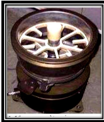
*Figure II.1.5 : Rhéomètre à béton BT Rhéom [50].*
