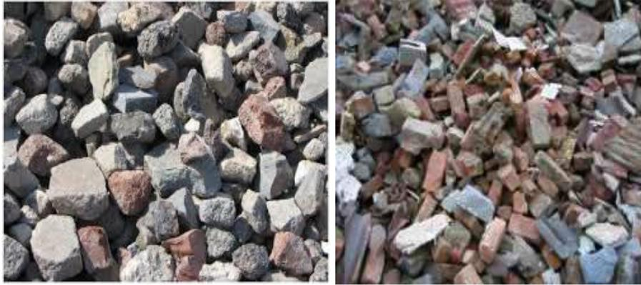
Figure II. 6 Différents types des granulats recyclés (Hannequart & E. Schamp 2010)
