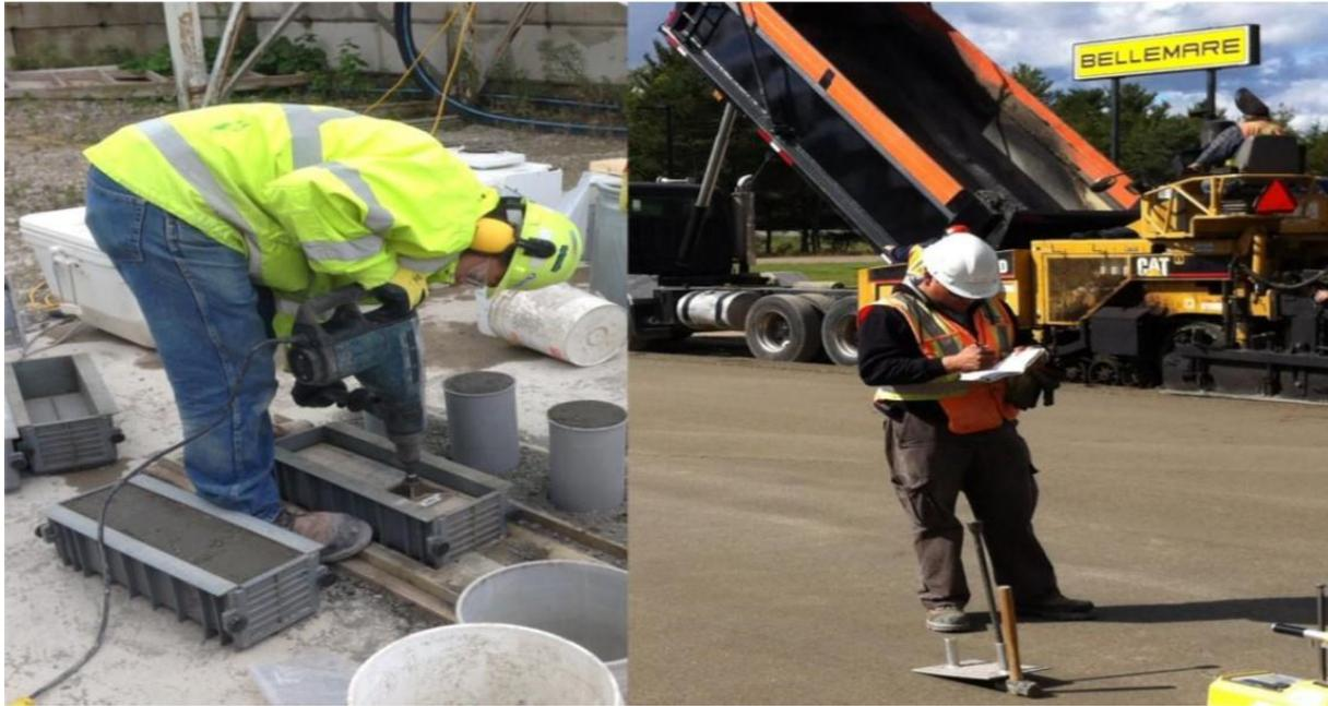
Figure I. 20 Contrôle du compactage
