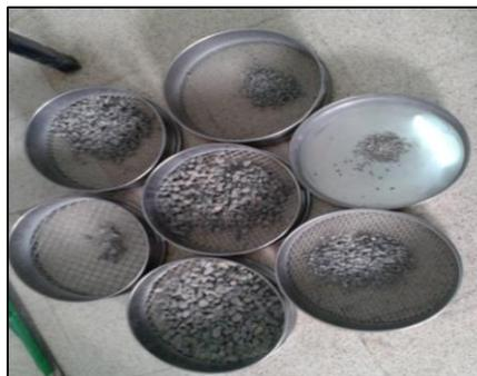
Figure III. 2 Fraction du gravier après tamisât.
