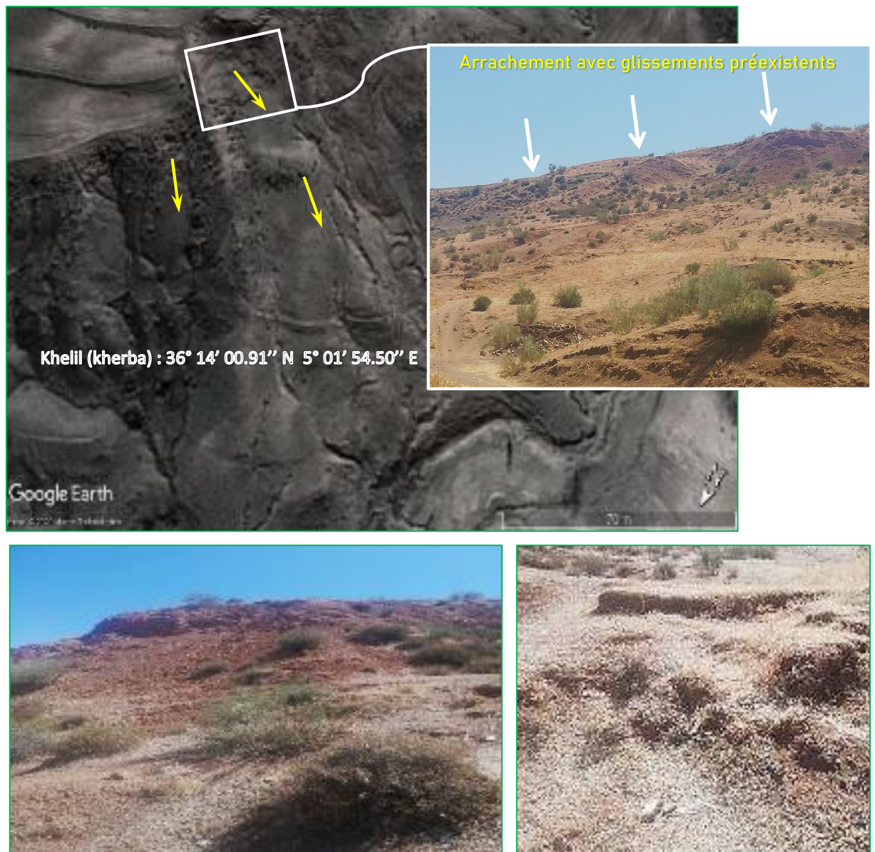
Figure 26 : Exemples de glissements provoqué par le séismes 2003 dans la zone d'étude.
