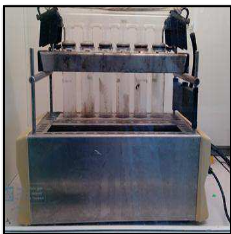
Figure 08: Minéralisateur (BÜCHI Digestion Unit K-424)
