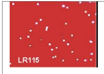
Figure 11. Traces de particules \alpha révélées dans les DSTN LR115.
