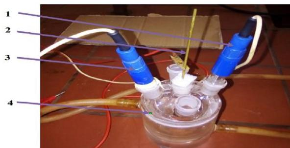
**Figure II.7:** Cellule électrochimique.
