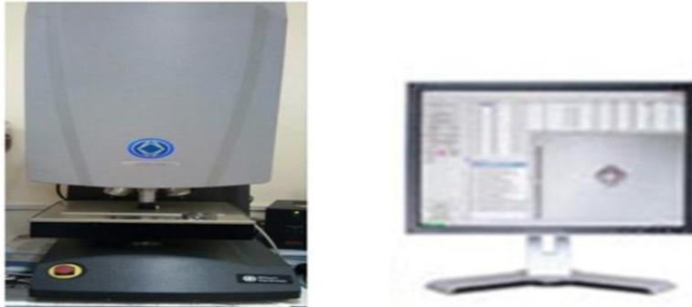
**Figure II.13** : Duromètre de type TUKON 2500
