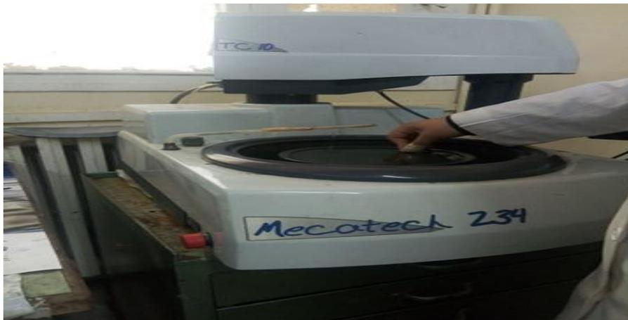
**Figure II.5** : Polisseuse mécanique demarqueMecatech 234 TC10.
