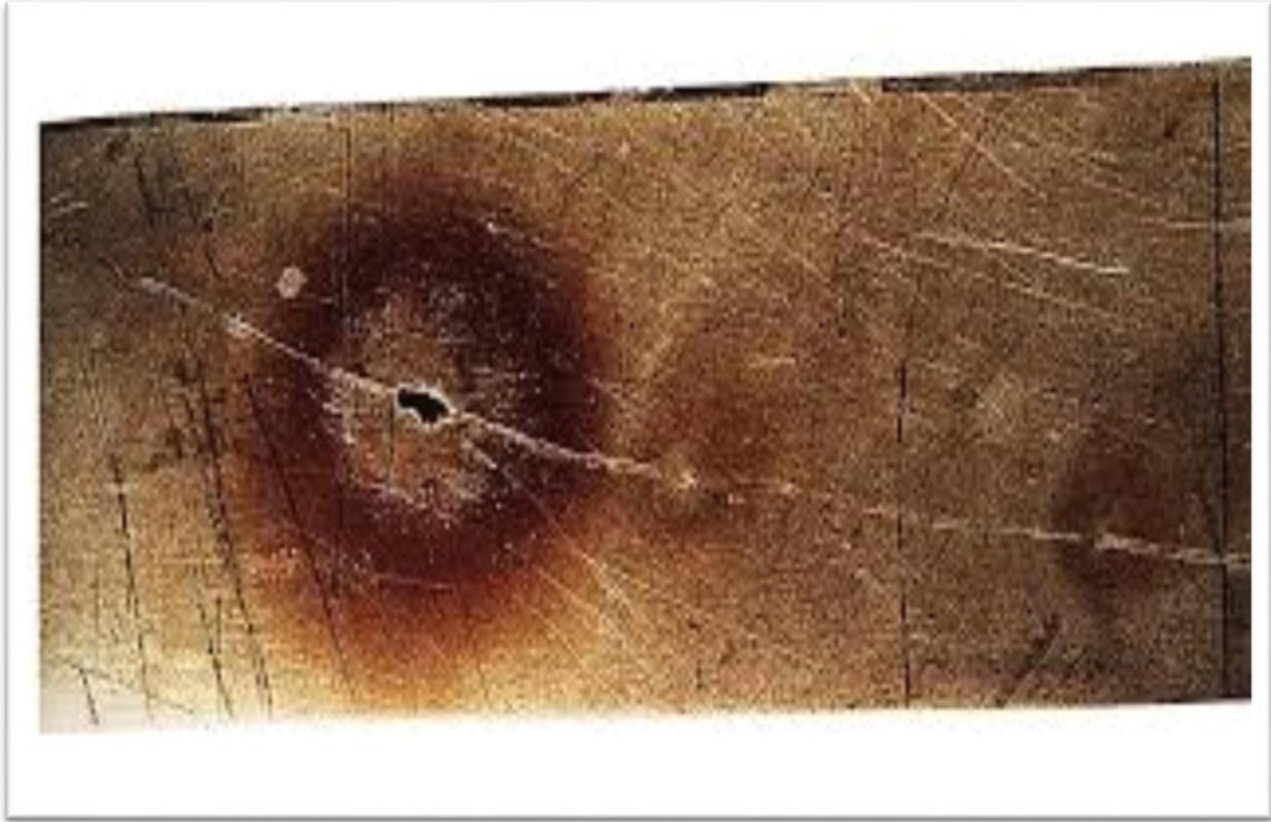
Figure I.4 : Corrosion Par piqûres
