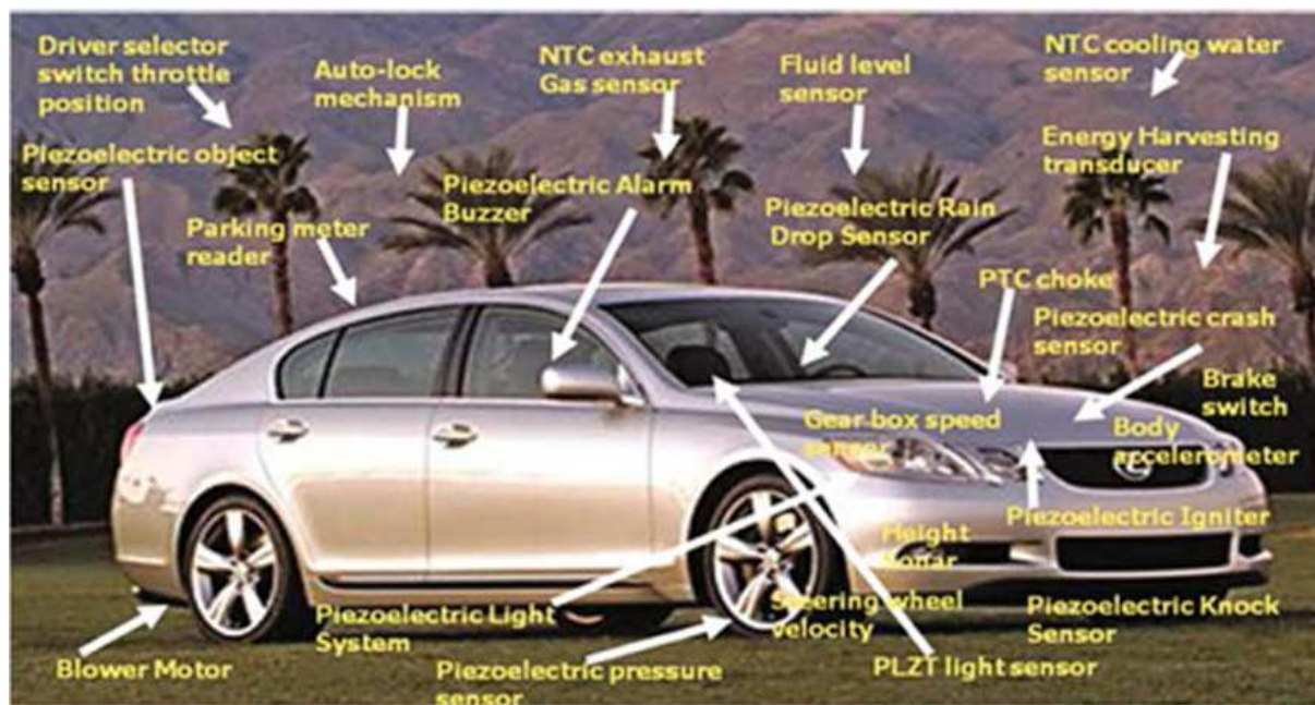
Figure I. 3: Placement des différents capteurs sur une voiture [7]
