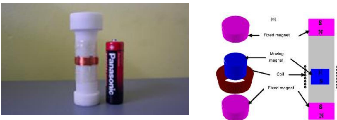
Figure I. 12: Générateur électromagnétique pour récupérer l'énergie [11]
