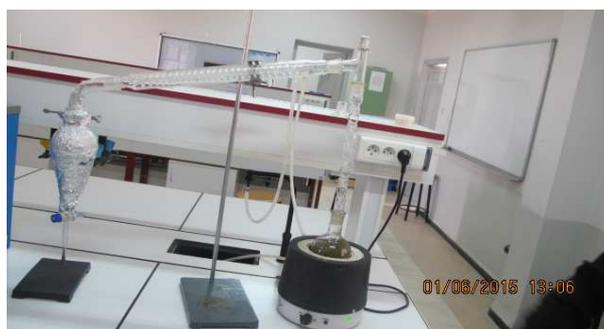
**Fig. 17:** Montage d'hydrodistillation employé pour l'extraction de l'huile essentielle.
