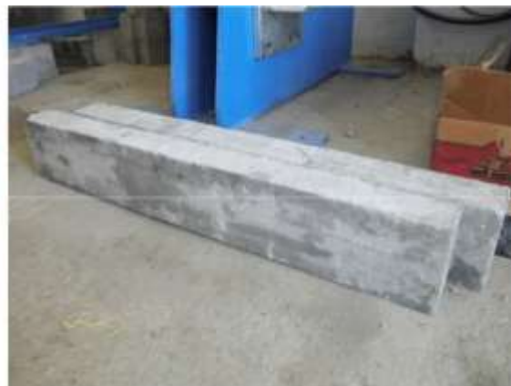
Figure 8.III.2: Murissement des poutres. Figure 9.III.2: poutres après 28 jours dans l'eau.
