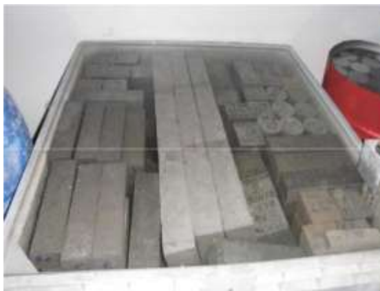
Figure 8.III.2: Murissement des poutres. Figure 9.III.2: poutres après 28 jours dans l'eau.
