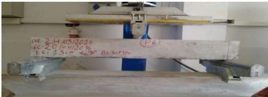
Figure 11.III.2: Essai de flexion type sur une poutre en béton armé.
