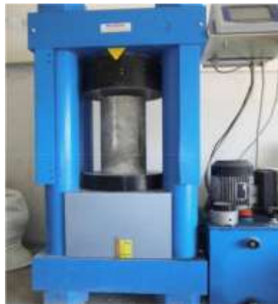
Figure6.I.2: Presse hydraulique capacité 3000 KN.
