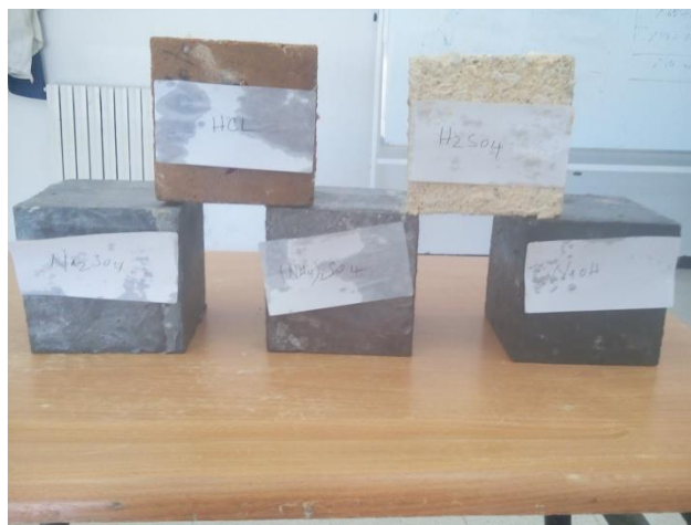
Photo IV.3 : Les éprouvettes après 28 jours d'immersion dans les milieux agressifs.
