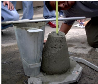
Photo III.11 : Essai au cône d'abrams.
