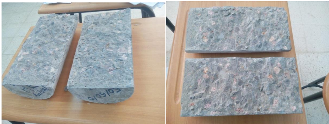
Photo IV.4 : Essai de traction par fendage.
