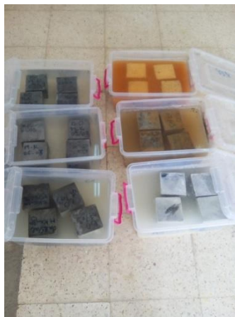
Photo III.15 : Conservation des bétons dans les milieux agressifs.
