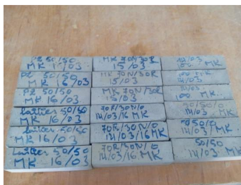
Photo II.7 : Les éprouvettes de mortier (4x4x16) cm 3
