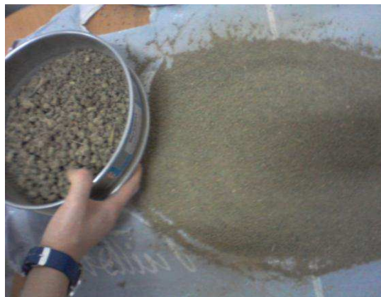
Figure13 : Tamisage d'échantillons de sol à mailles de 2mm de diamètre
