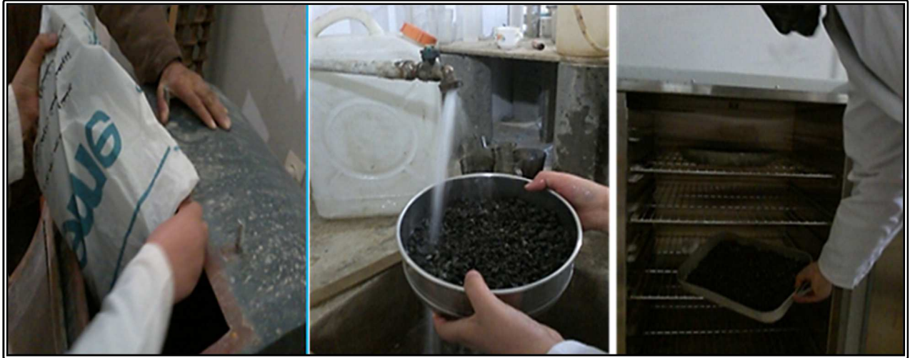
Photo 24 – Déroulement de l'essai Los Angeles.
