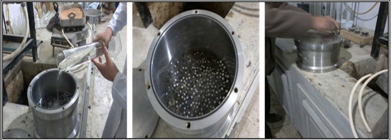
Photo 21 – Préparation de l'échantillon dans le cylindre.
