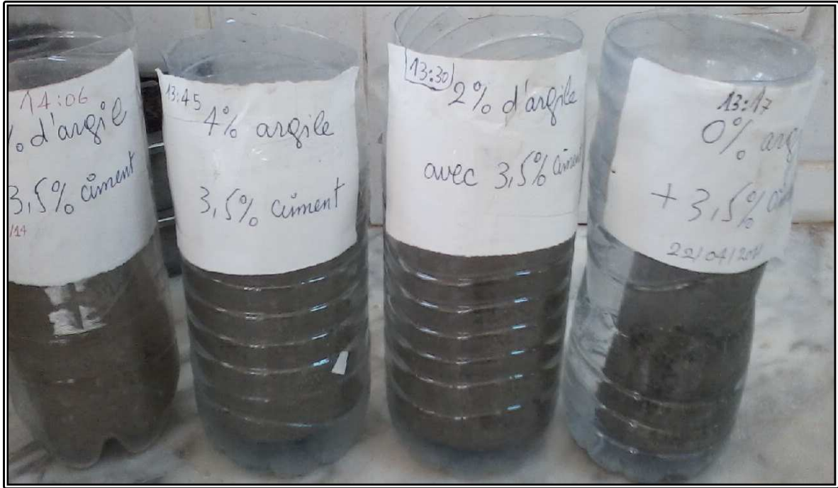
Photo 40 – Stabilité des éprouvettes des graves-ciments dans l'eau.
