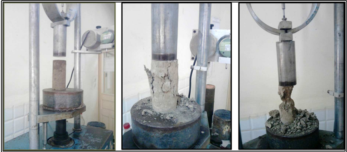
Photo 29 – Ecrasement d'une éprouvette de grave ciment.
