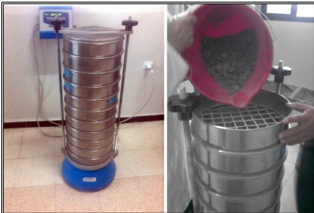
Photo 8 – Vibration mécanique de la colonne des tamis.
