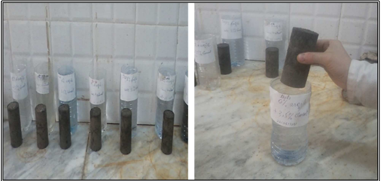
Photo 37 – Eprouvettes plongées dans de l'eau.
