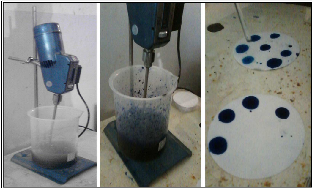
Photo 15 – Exécution de l'essai au bleu.
