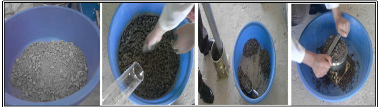
Photo 26 – Réalisation de l'essai Proctor sur la fraction 0/14 mm.
