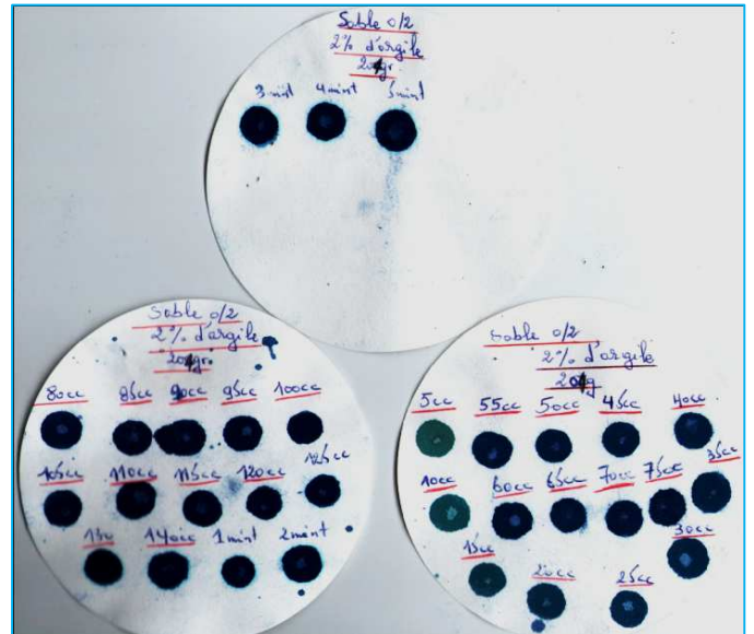
photo 2 – feuille minute de l'essai VB pour un dosage de 2 % d'argile.
