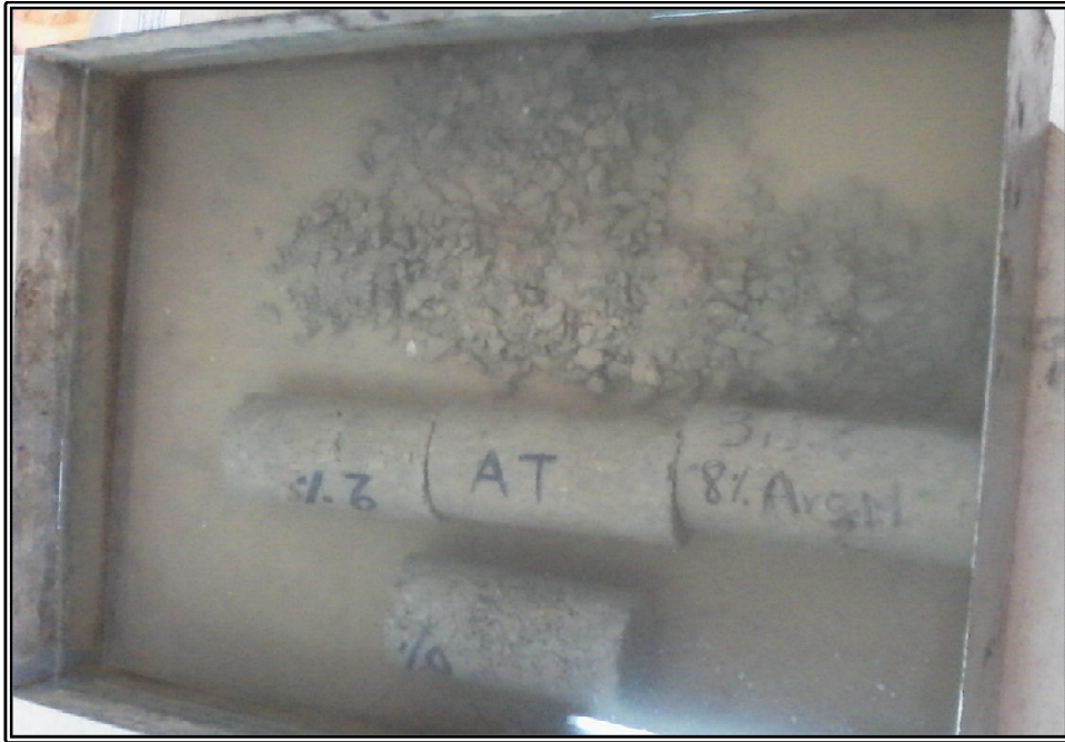
Photo 38 – Eprouvettes plongées dans un bac d'eau.
