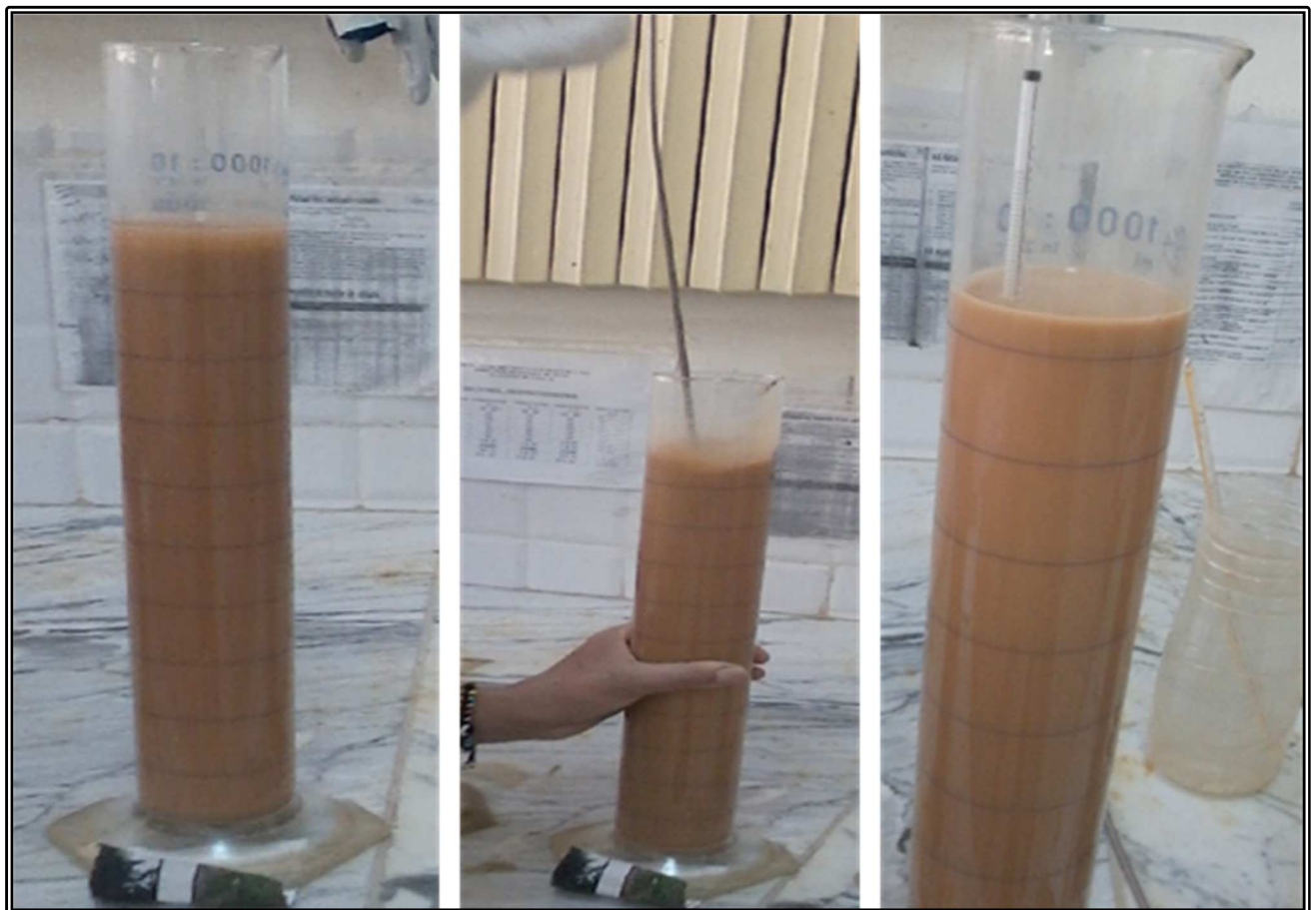
Photo 13 – Exécution de l'essai pour l'argile.
