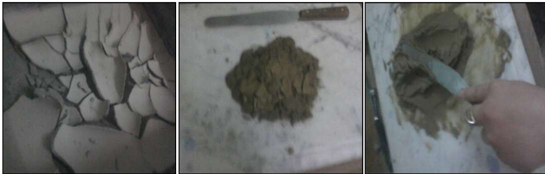
Figure IV.6 : Préparation de sol pour détermination des limites d'Atterberg.
