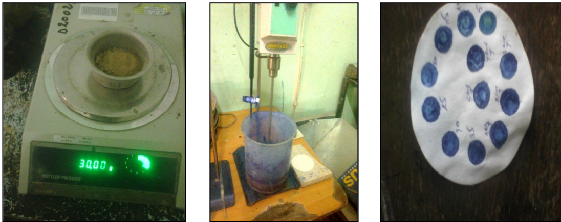
Figure IV.15 : Matériaux et matériel pour essai au bleu de méthylène.
