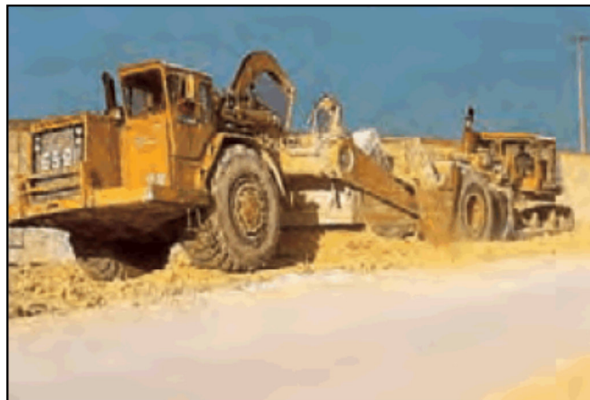
Figure III.3 : Extraction en couche [7].
