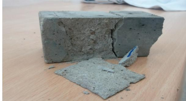
Figure (IV .5) : Epreuve de mortier après l'essai de compression
