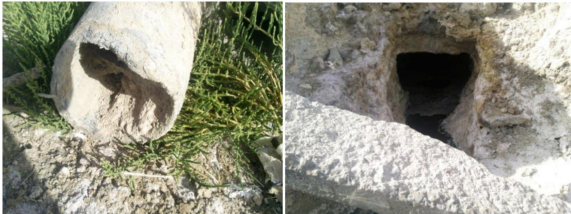
**Figure(II.10) :** Dégradation sur les conduites en amiante
