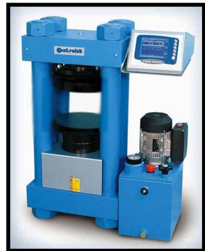
**Figure IV.8 :** Presse hydraulique capacité 3000 KN.
