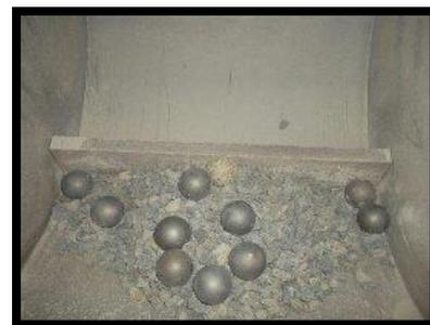
**Figure IV .3 :** L'échantillon et les boules avant l'essai.
