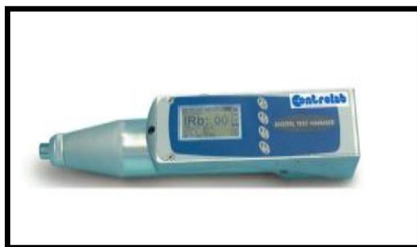
Figure IV.11: Scléromètre digital.
