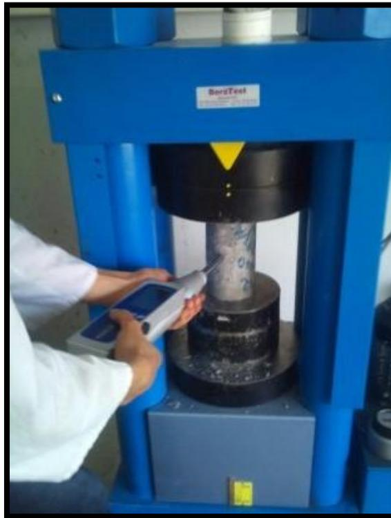
Figure IV.12 : Exécution de l'essai sclérométrique.
