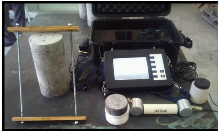
**Figure IV .9 :** Essai d'ultrasons et ses équipements.
