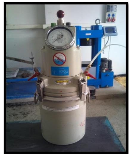
*Figure IV.7 : Aéromètre à béton de 8 litres.*
