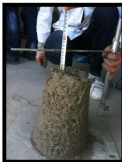
**Figure IV.6 :** *Mesure de l'affaissement.*
