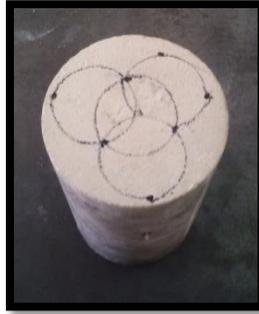
Figure III.10 : Marquage des points des mesures sur éprouvette.
