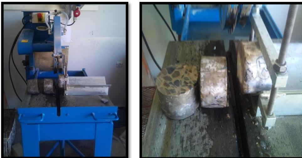
Figure IV.13 : Préparation des éprouvettes.
