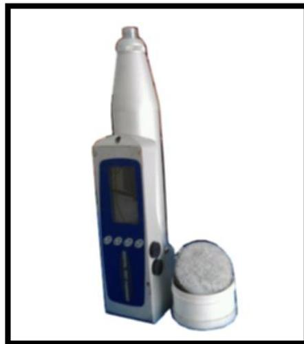
Figure III.6 : Scléromètre digital.
