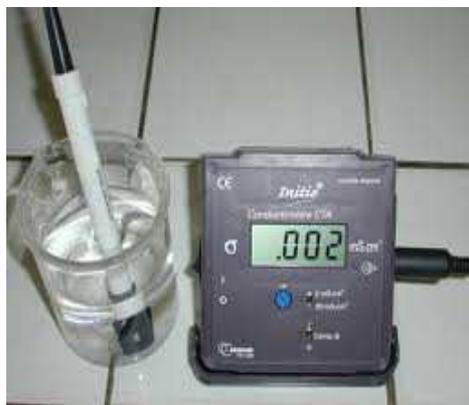
**Figure 05 : un conductimètre**
