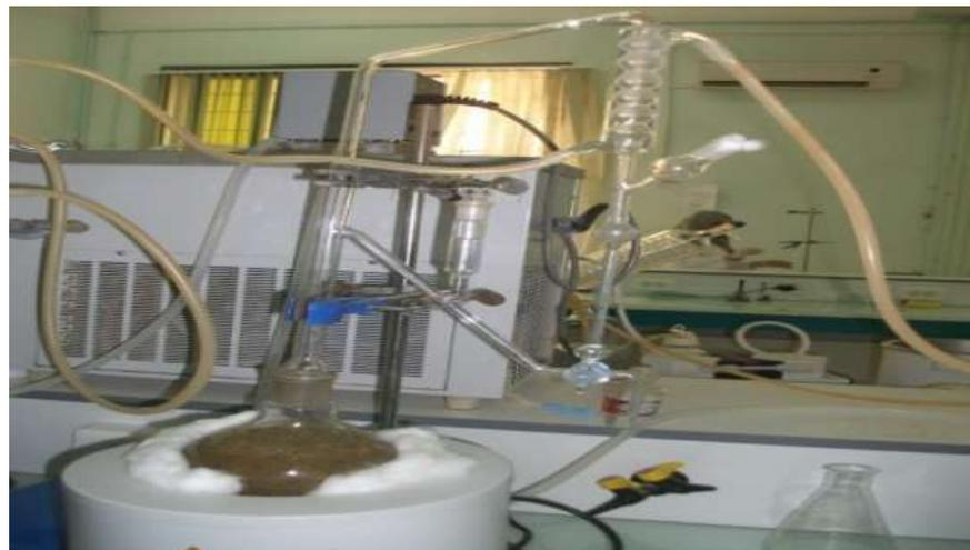
**Figure 2.8.** . Dispositif d'extraction par hydrodistillation des huiles essentielles à l'aide d'un appareil de type Clevenger (Originale, 2015).
