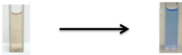
Figure 9. Changement de couleur due à une réduction du molybdate d'ammonium (Jaune) par le noyau phénol (Bleu) (Agbor et al., 2014).
