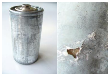
Figure I.12 a : Une pile saline neuve. b : Une pile saline usagée (gros plan).
