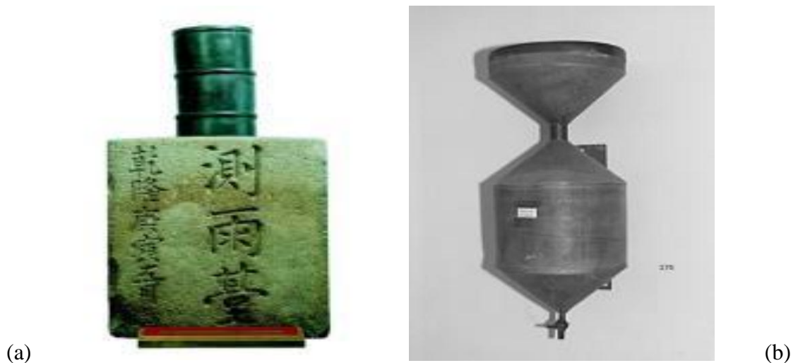
Fig.2 : Pluviomètre coréen datant du 15ème siècle (a) et pluviographe du 20ème siècle (b) ( source : météo France, www.meteo.fr )
