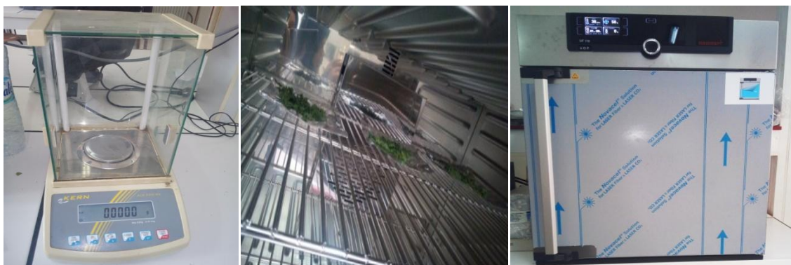
Figure 19 : Photographie de l'étuve et de la balance.
