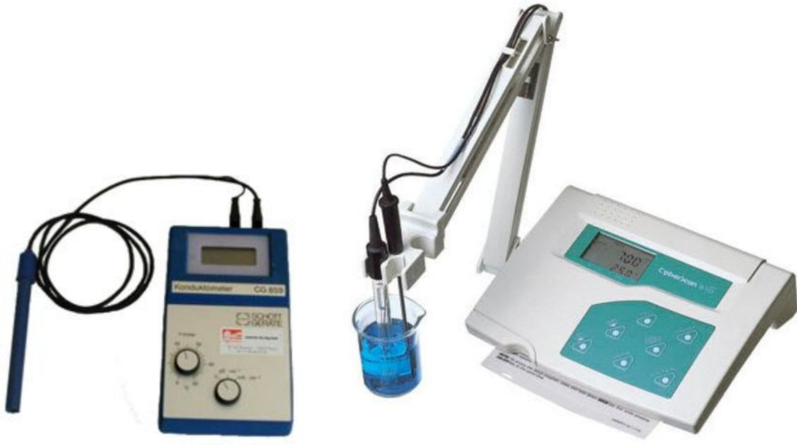
**Figure I.4 :** Quelques exemples des capteurs chimiques (conductimètre et pH-mètre) [2].
