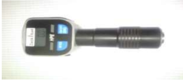
Figure III.4 : Instrument de mesure de la dureté Shore D.
