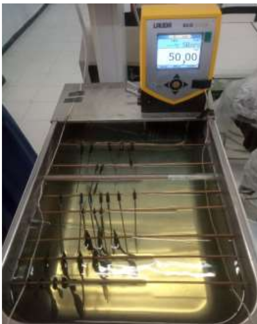
Figure III.1 : Bains d'exposition hydrolytique fonctionnant à 50°C.
