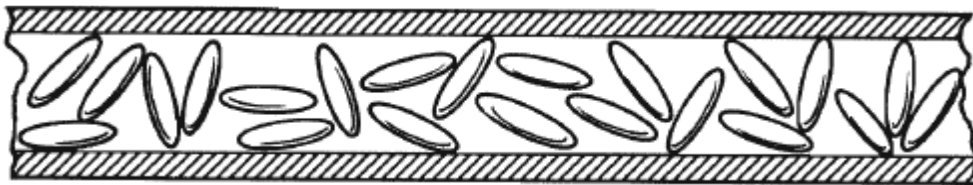
Figure (I.8) : propagation du riz dans une soufflette lorsque la taille des particules de riz est petite par rapport à la géométrie de la section transversale du tube.
