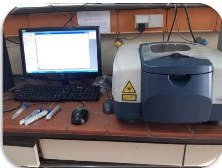
**Figure II.5 :** Spectroscopie Infrarouge à Transformée de Fourier (FTIR).
