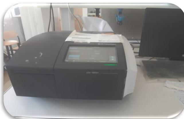
**Figure II.3 :** Spectrophotomètre ultraviolet (UV-1900 SHIMADZU).
