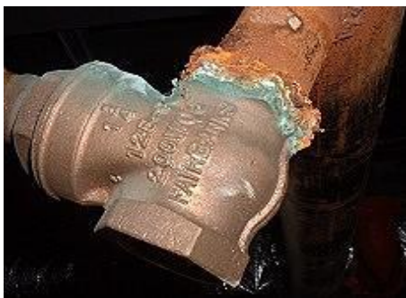
Figure I.4 : Corrosion galvanique résultante d'un assemblage de deux métaux différents / robinet en cuivre et conduite en acier galvanisé [9].
