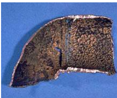
Figure I.9 : Aspect et mécanisme de la corrosion-érosion [14].
