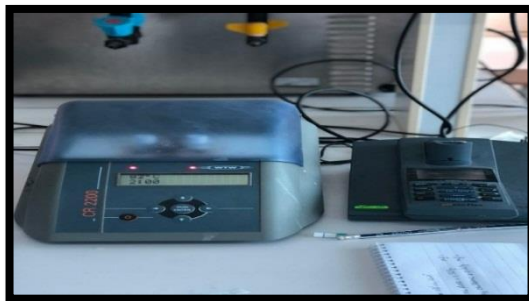
Figure.IV.9. Spectrophotomètre utilisé pour l'analyse de la DCO.
