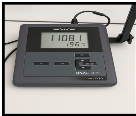
Figure.IV.6. Conductimètre utilisé pour les mesures.
