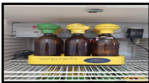
Figure.IV.8. DBO-mètre utilisé pour les mesures.
