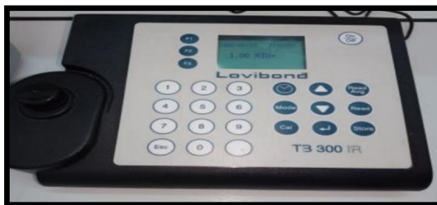
Figure.IV.7. Turbidimètre utilisé pour les analyses.
