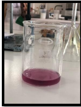
Figure.IV.12. Virage de couleur au violet pour la détermination du TH-Ca.
